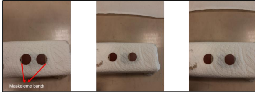
Şekil 3.4: Sinterlenmiş seramik disk numunelerin elektrotlama işlemi öncesinde maskelenmesi.
