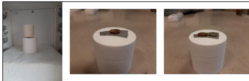
Şekil 3.6: Ag-Pd elektrot katmanlarının birlikte pişirilmesi ( 600^{\circ}\text{C} – 30 dk.).
