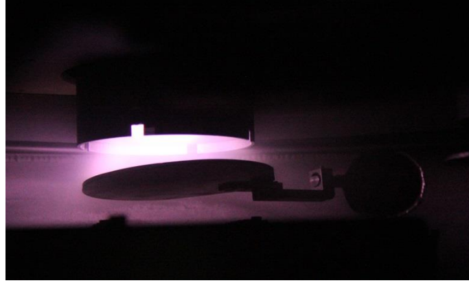
Şekil 5.4: Argon gazı ile platin hedef malzeme altında oluşturulmuş plazmanın görünümü.
