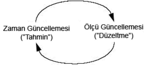
Şekil-3.1. Kalman filtresi döngüsü.
