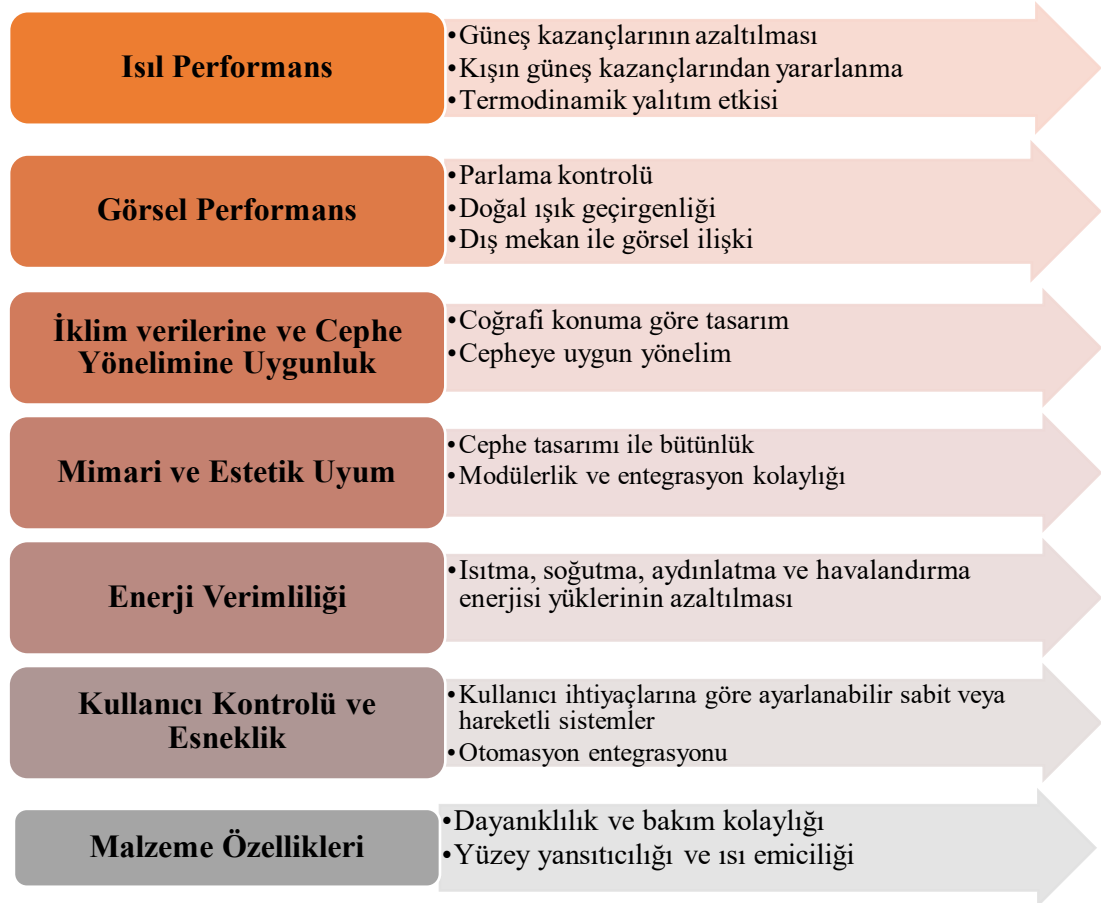
Şekil 3.5: Güneş kontrol elemanlarından beklenen temel performans özellikleri [Yazar tarafından oluşturulmuştur.]
