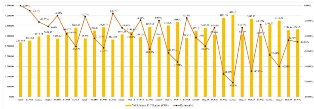
Şekil 5.15: Güney zonu yatay eleman senaryolarının yıllık ısıtma enerjisi tüketimleri ve kazanç değerleri.
