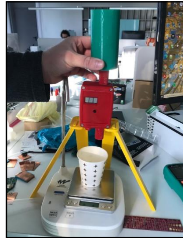
Şekil 7.2: Sıvı ölçer cihaz masaüstü test düzeneği.
