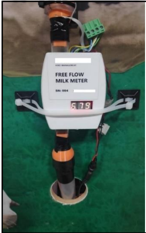
Şekil 7.1: Sıvı ölçer cihazın ilk prototipi.
