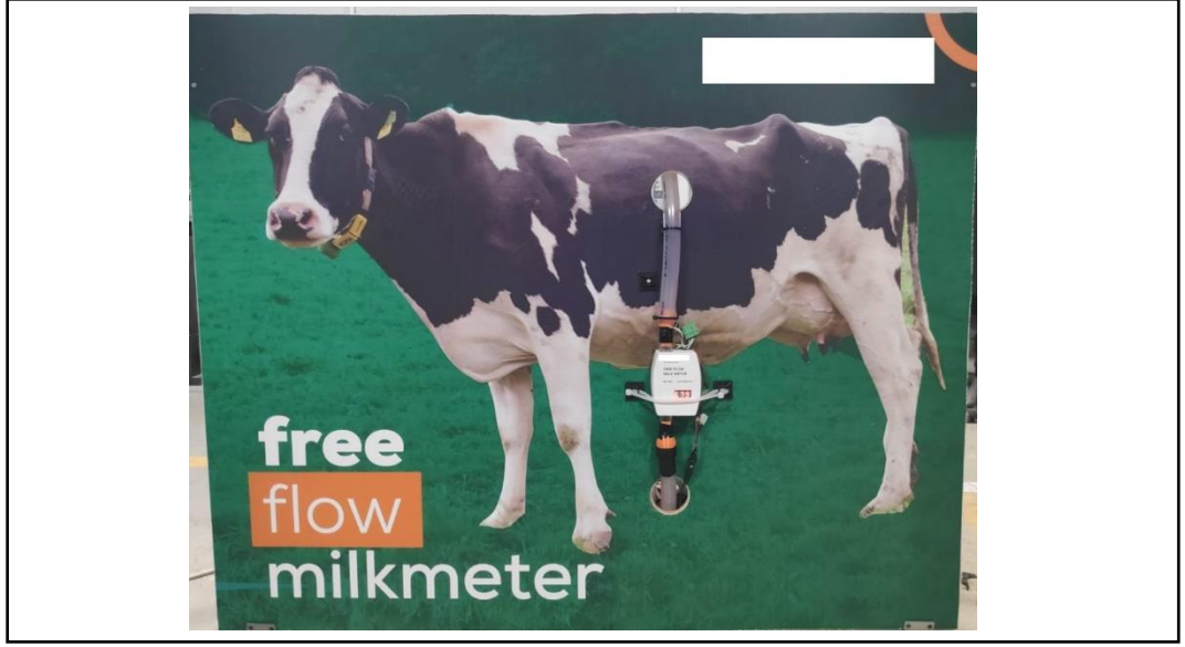
Şekil 7.3: Test düzeneğine prototip montajı.
