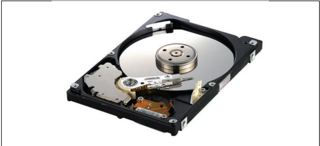
Şekil 3.3: Kapton'un hard disk içindeki uygulaması.
