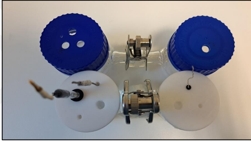
Şekil 3.3: İki farklı H-tipi elektrokimyasal hücrenin yukarıdan gösterimi.
