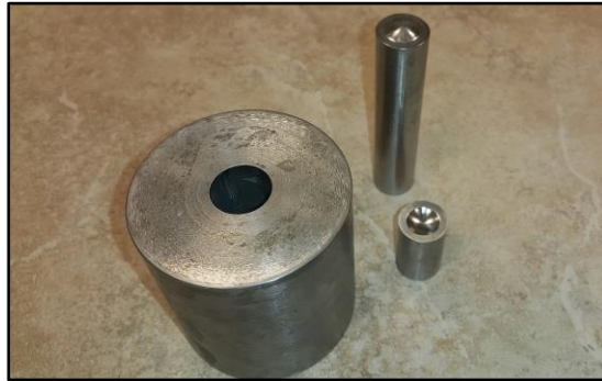
Şekil 3.11: Seramik kabuk üretiminde kullanılan toz pres kalıbı.
