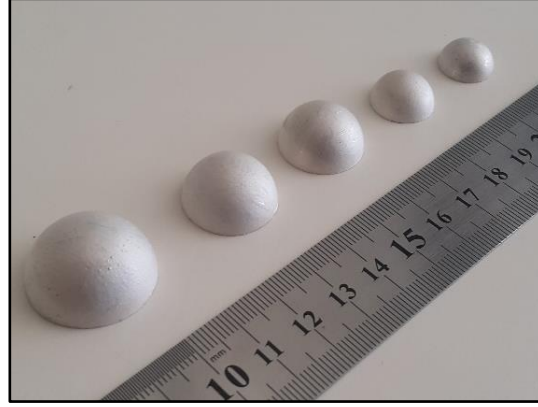
Şekil 3.8: Asıltı döküm yöntemiyle üretilmiş gümüş elektrot kaplı farklı çaplarda içi boş yarı küreler.
