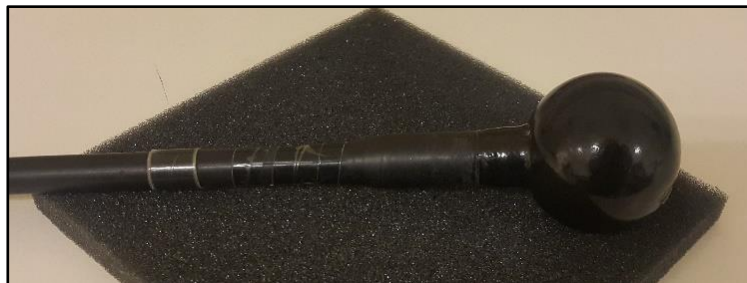
Şekil 3.9: Su altı akustik ölçümü için hazırlanmış poliüretan kaplı hidrofon.
