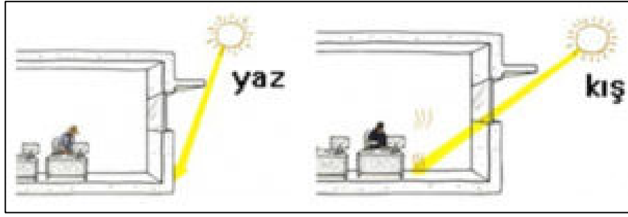
Şekil 2.19: Yatay gölgeleme elemanlarının yaz ve kış mevsiminde çalışma prensibi [Web 4, 2021].
