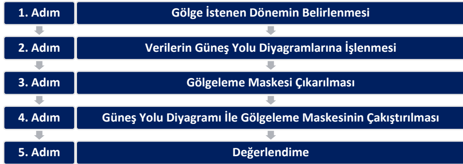
Şekil 2.8: Gölgeleme elemanı tasarım yöntemi akış şeması.
