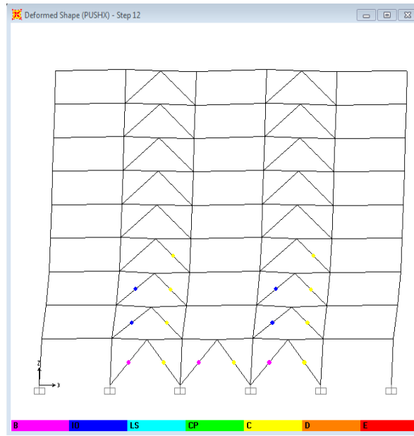
Şekil 4.8. Merkezi çaprazlı çerçeveye ait hedef yer değiştirmede itme analizi sonucunda oluşan plastik mafsallar
