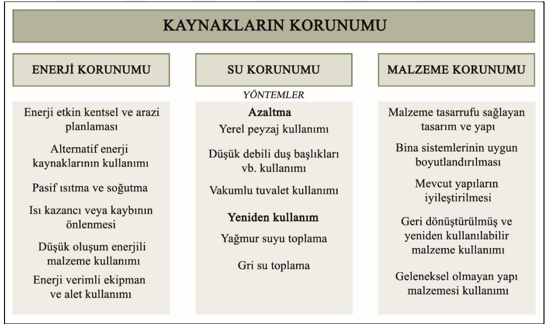
Şekil 2.6: Sürdürülebilir mimari kaynakların korunumu ilkeleri ve yöntemleri.
