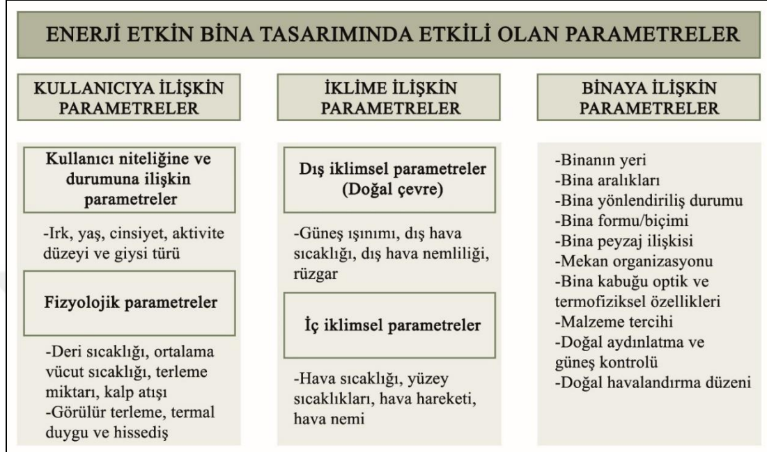
Şekil 2.7: Enerji etkin bina tasarımında etkili olan parametreler (şekil yazar tarafından düzenlenmiştir).
