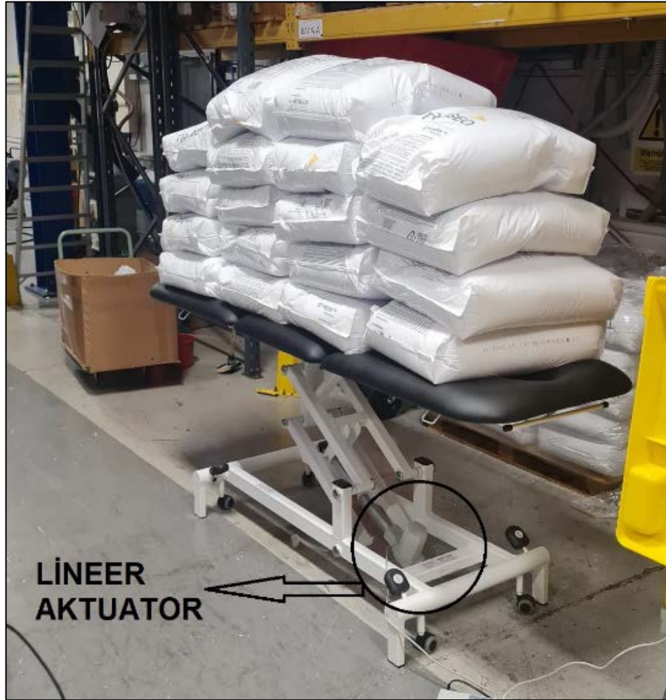
Şekil 3.15: Muayene Masasının Statik Test Fotoğrafi (450kg).
