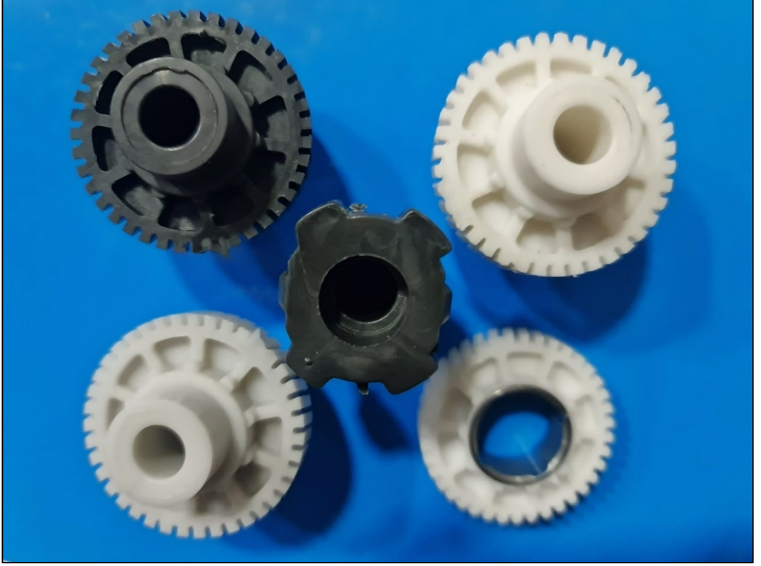
Şekil 1.5: POM Malzemedan Enjeksiyon Metodu ile Üretilmiş Dişliler.
