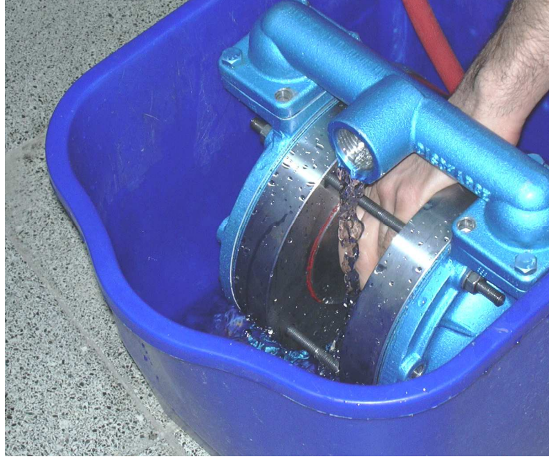
Şekil 4.17. Pompanın İlk Çalıştırma Denemesi.
