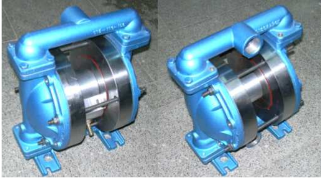
Şekil 4.13. Yeni Tasarımın Montaj İşlemi Yapılmış Hali.
