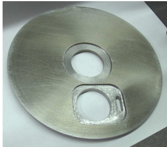
Şekil 4.10. Hava Odası İç Duvarının İmal Edilmiş Hali.
