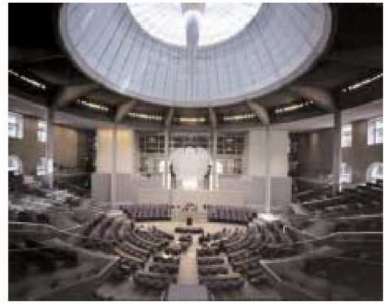
Resim 21. Ayna Kaplı Ters Koni Şeklindeki Havalandırma Bacası ve Toplantı Salonunun Doğal Aydınlatılması
