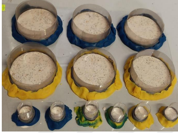
Şekil 3.6: Ses geçiş kaybı ve ses yutum deneylerinin uygulanacağı numunelerin hazırlanması.
