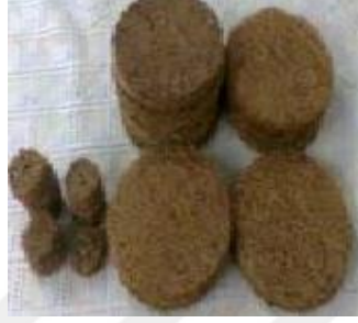
Şekil 2.5: Hindistan cevizi lifinden elde edilen test numunesi.
