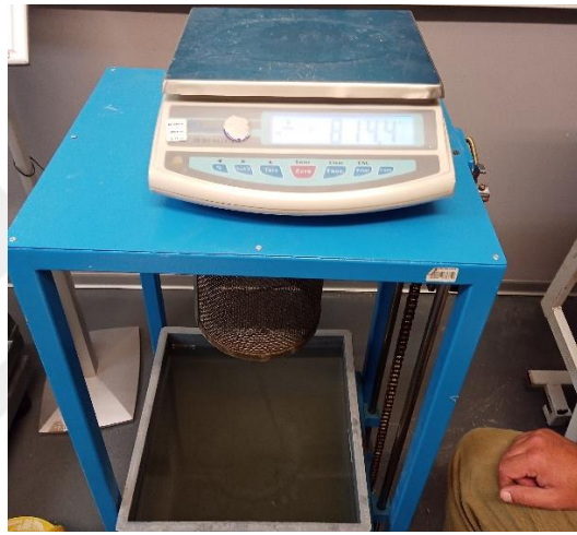
Şekil 3.10: Hacimce ve ağırlıkça su emme deney düzeneği.
