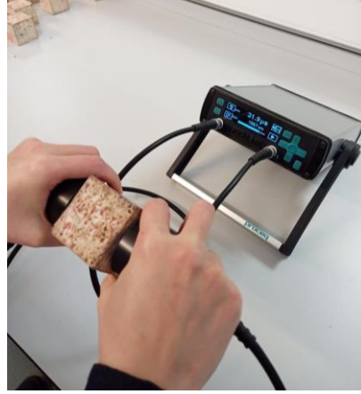
Şekil 3.11: Ultrases geçiş hızı deney düzeneği.
