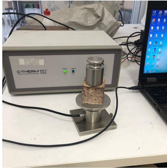
Şekil 3.14: Termal iletkenlik deney düzeneği.
