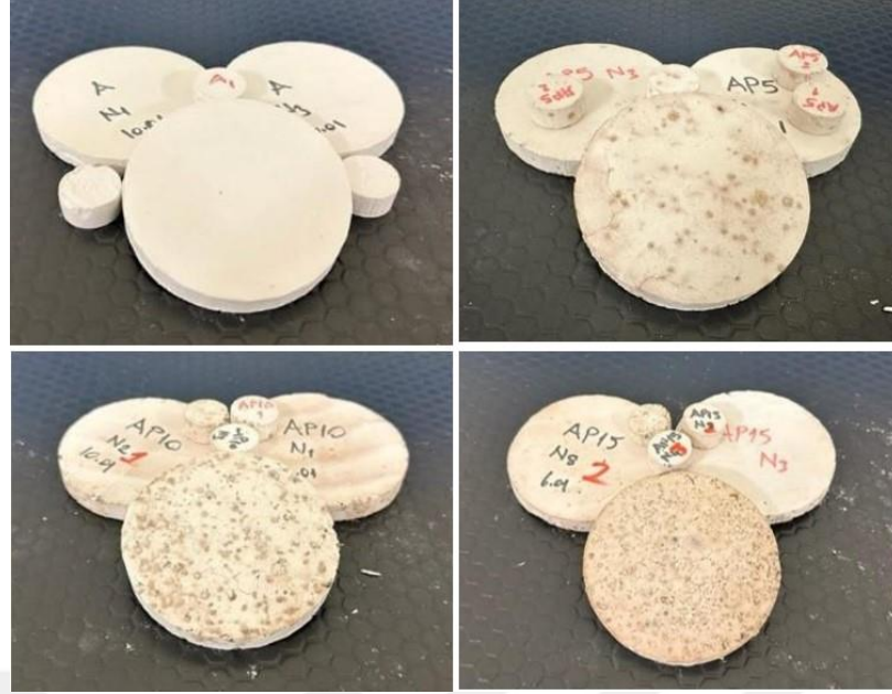
Şekil 3.12: Ses geçiş kaybı ve ses yutum ölçümlerinde kullanılan deney numuneleri.
