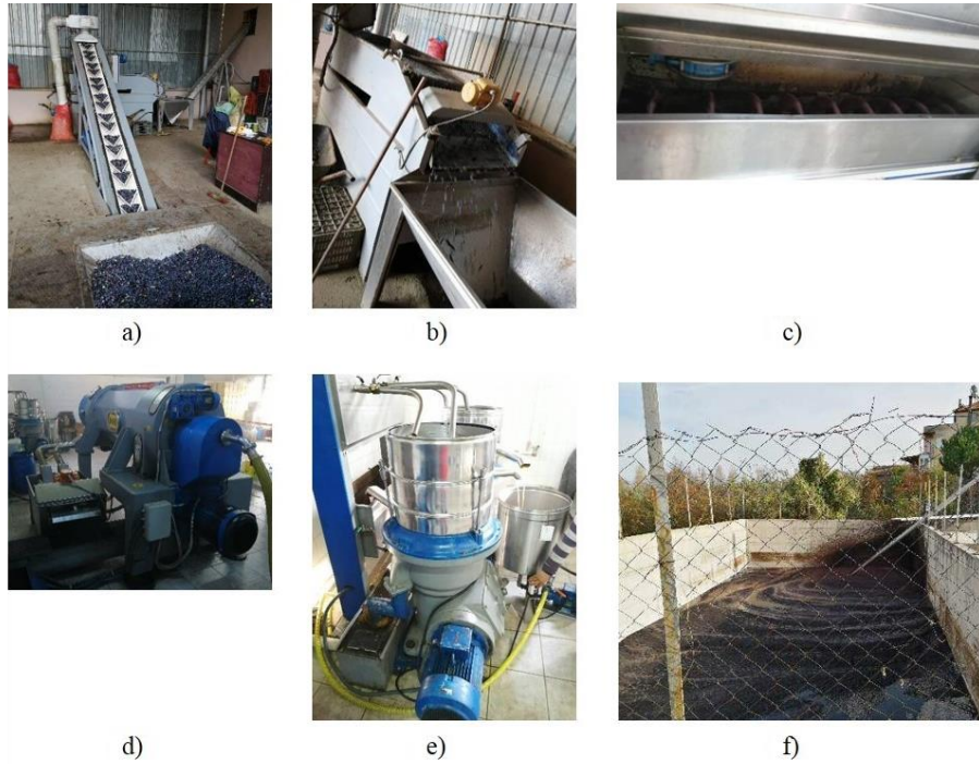
Şekil 2.13: Körfezim Yağhanesi zeytinyağı üretim aşamaları; a) Bant sistemi üzerinde yıkama alanına taşıma, b) Yaprak ayırma ve yıkama, c) Kırma, d) Yoğurma (Malaksasyon), e) Santrifüjleme, f) Depolama (Pirina ve karasu).
