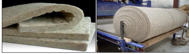
Şekil 2.7: Koyun yününden elde edilen yalıtım malzemesi.
