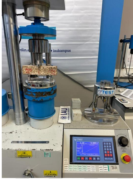
Şekil 3.17: Eğilme dayanımı deney düzeneği.
