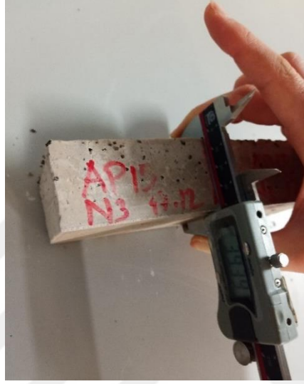
Şekil 3.7: Boy değişiminin kumpas ile ölçümü.
