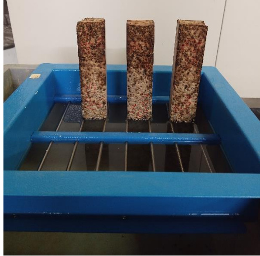
Şekil 3.8: Kılcal su emme deney düzeneği.
