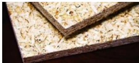
Şekil 2.2: Kenevirden elde edilen levha.
