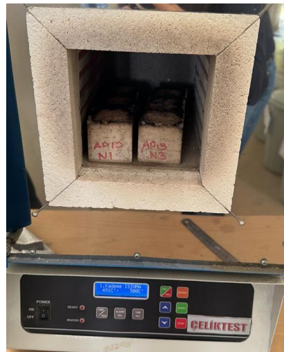
Şekil 3.16: Organik madde muhtevası deney düzeneği.
