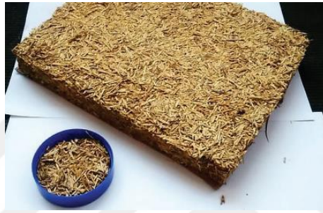
Şekil 2.3: Keten ve ketenden elde edilen yalıtım malzemesi.
