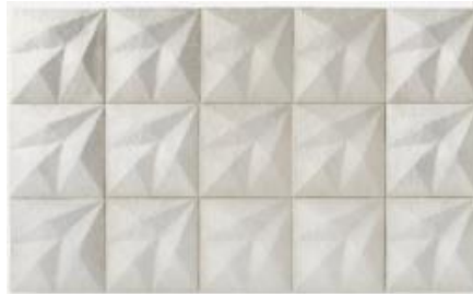
Şekil 2.8: Miselyum mantarından elde edilen akustik panel.
