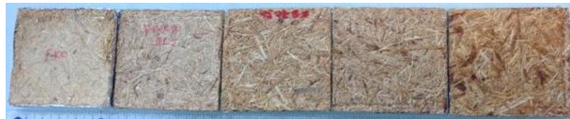
Şekil 2.4: Bambudan elde edilen yalıtım levhası.
