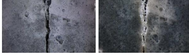
Şekil 2.9: Bacillus Pseudofirmus ve Sporosarcina Pasteurii bakterilerinin betondaki çatlağı iyileştirmesi.
