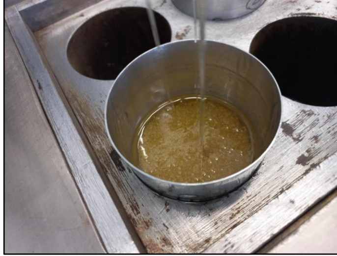
Şekil 3.3: Isıtıcı plaka içerisinde metal kaplarda hazırlanmış HMA karışımı.
