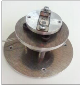
Şekil 3.9: Dönel kaplama düzeneği.
