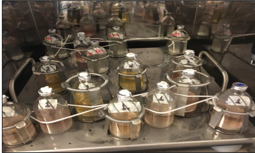
Şekil 3.1: Kesikli biyoreaktör düzeneği.
