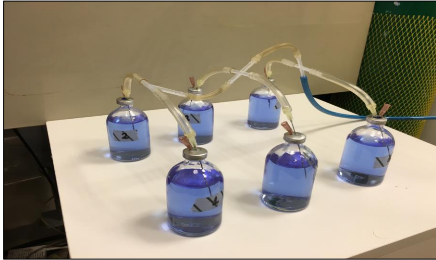
Şekil 3.2: Kesikli biyoreaktörlerin argon gazı ile oksijensizleştirilmesi.
