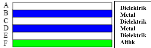
Şekil 2.2. Çok katmanlı soğurucu film yapısının şematik tasarımı
