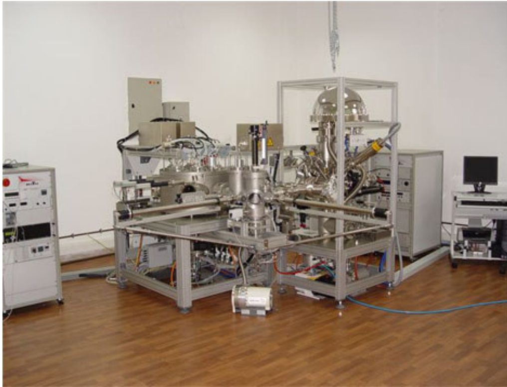
Şekil 4.12. XPS analizleri için kullanılan deney düzeneği
