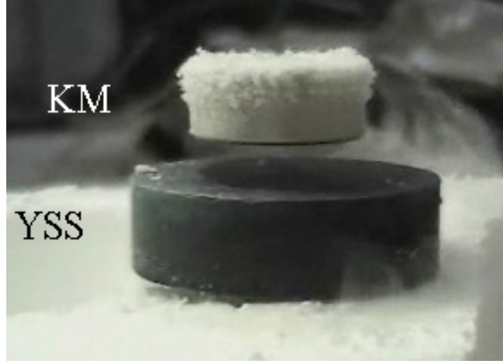
Şekil 1.1. Kalıcı Mıknatısın (KM) bir Yüksek Sıcaklık Süperiletkeni (YSS) üzerindeki manyetik levitasyonu (GYTE Deney)
