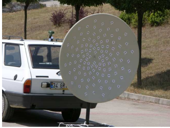
Şekil 3.4 Resimlerin yöneltmesi için hazırlanmış kontrol noktaları
