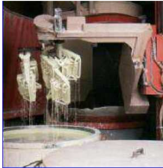
Şekil 2.9. Seramik çamur kaplama için robot kullanımı [10]
