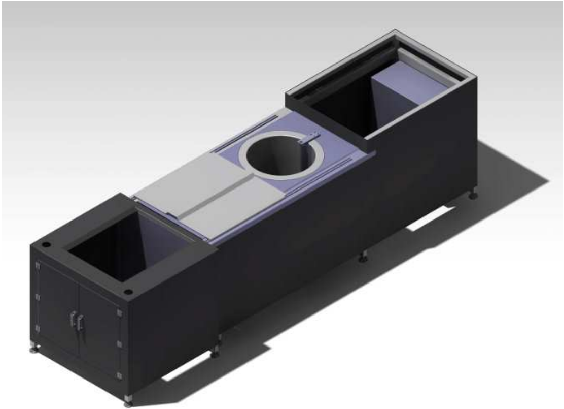
Şekil 4.7. Seramik kalıp makinesi için seramik karıştırıcı tankı perspektif görünüşü
