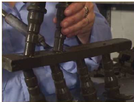
Şekil 2.6. Mum modelin salkım parçalarının elle birleştirilme işlemi [7]
