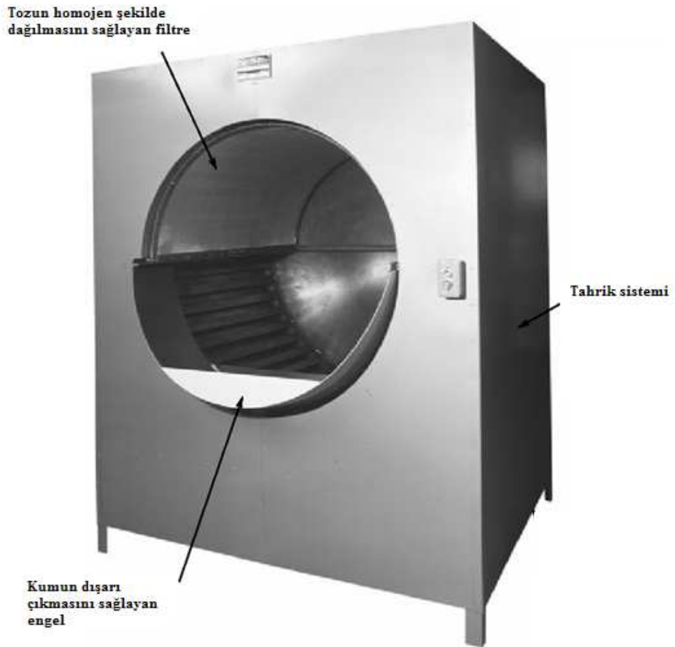
Şekil 3.8. Rotary tip toz yağmurlama ünitesi [25]
