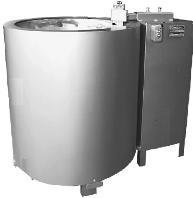
Şekil 3.1. Sabit destekli tip seramik çamur karıştırma tankı [18]
