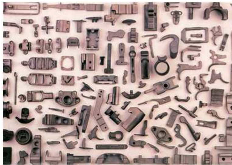
Şekil 1.1. Çeşitli hassas döküm parçaları [7]
