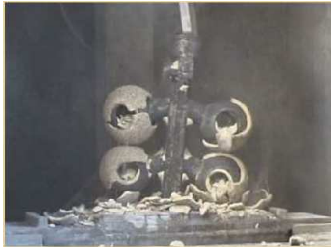
Şekil 2.15. Seramik kabukların kırılması [7]
