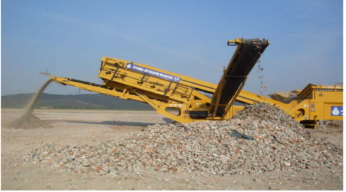
Şekil 2.9. Tuzla yapısal atık geri kazanım tesisinde bulunan moloz atıkları tane boyutuna göre ayıran ekipman
