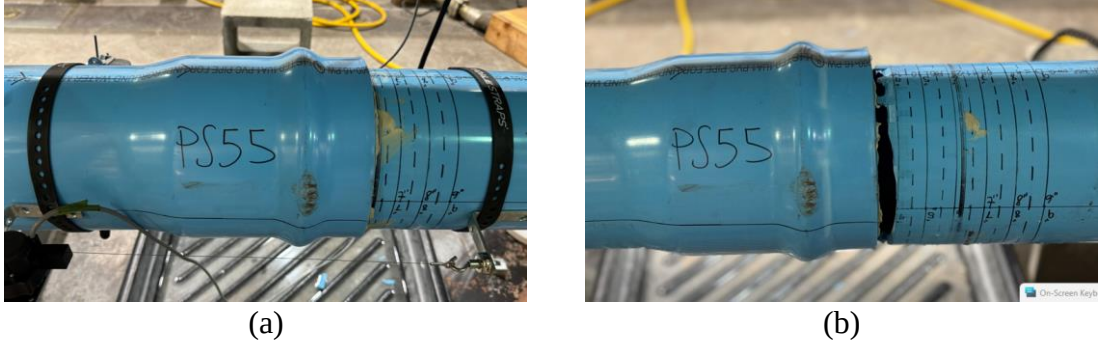
Şekil 5.60: a) Testten önce PS55 birleşimi ve b) bağlantı hasarı.
