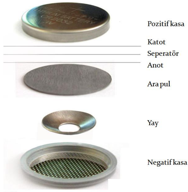
Şekil 3.2. Düğme pil parçaları ve dizilim sırası.
