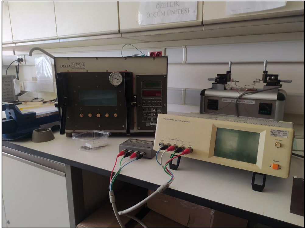
Şekil 3.3: Sıcaklığa bağlı dielektrik katsayısı ölçüm düzeneği.
