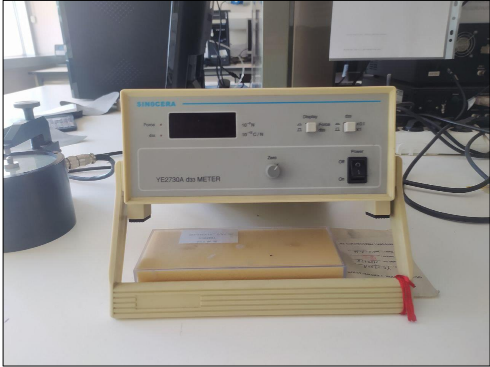
Şekil 3.4: Piezoelektrik d_{33} yük katsayısı ölçüm cihazı.
