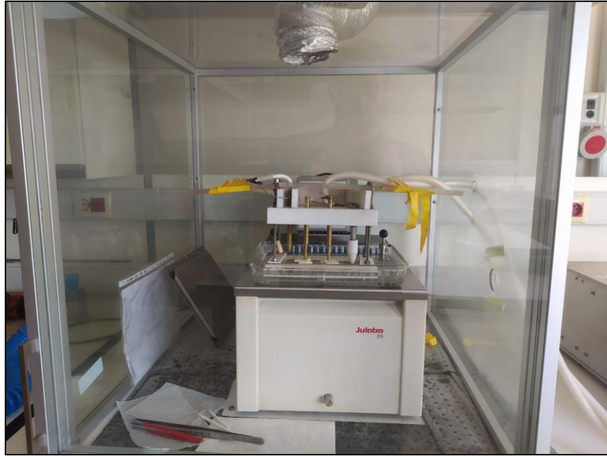
Şekil 3.2: Kutuplama işleminin gerçekleştirildiği düzenek ve yağ banyosu.
