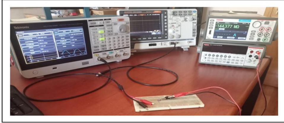
Şekil 3.19: AC elektriksel ölçüm düzeneği.
