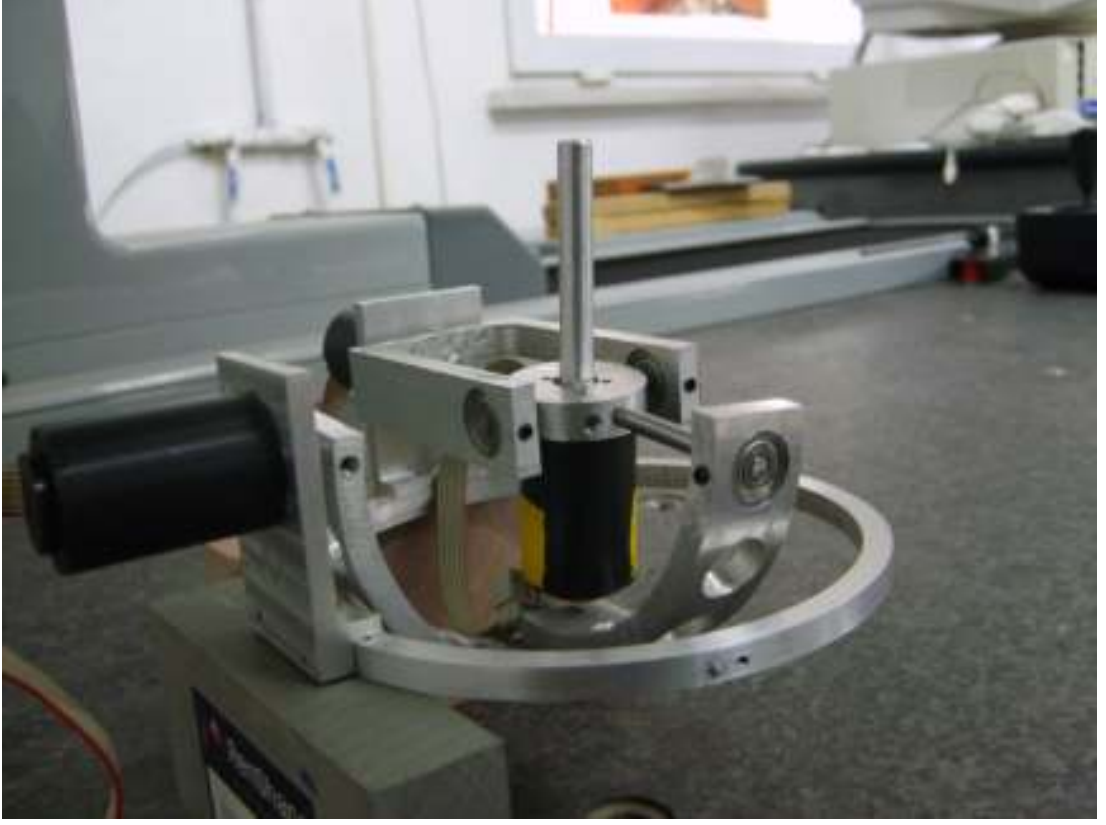
Şekil 5.2. Uzaysal Yalpa Mekanizması
