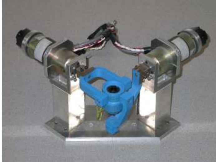
Şekil 3.3. İki Serbestlik Dereceli Agile Eye Mekanizması
