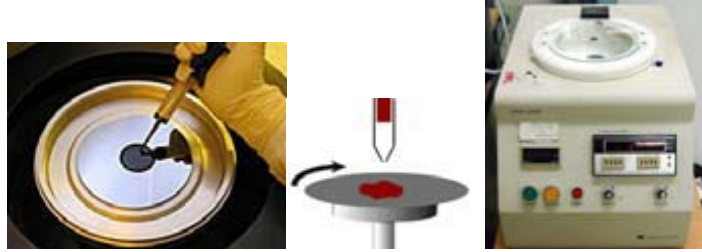
Şekil 4.1 Sol-jel Spin kaplama sistemi
