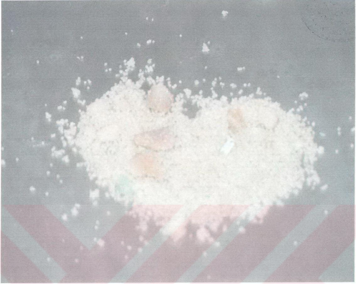
Şekil 4.10 Üçüncü Kolondan Deneyler Sonunda Çıkarılan Yüzey Aktif Maddeli Bilyeler
