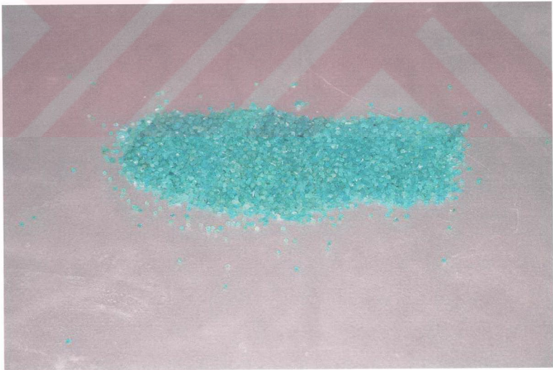
Şekil 4.9 İkinci Kolondan Deneyler Sonunda Çıkarılan Yüzey Aktif Maddesiz Bilyeler
