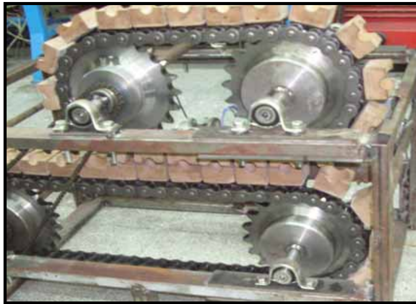
Şekil 5.4. Prototip üzerinde kayısı paletlerinin oluşturduğu konveyör hattı
