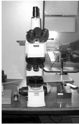
Şekil 6.4. Takım aşınmasının tespitinde kullanılan optik mikroskop.
