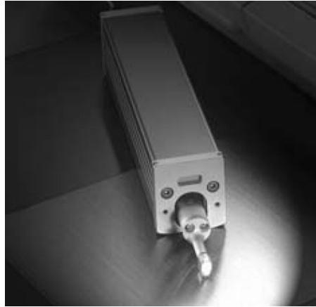
Şekil 4.8. Bir stylus ucunun gerçek iş parçası üzerinde izleme yapması
