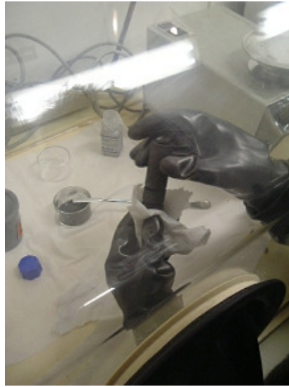
Şekil 3.8 Glove-box (eldivenli kutu), tozlar doldurulurken kullanılır
