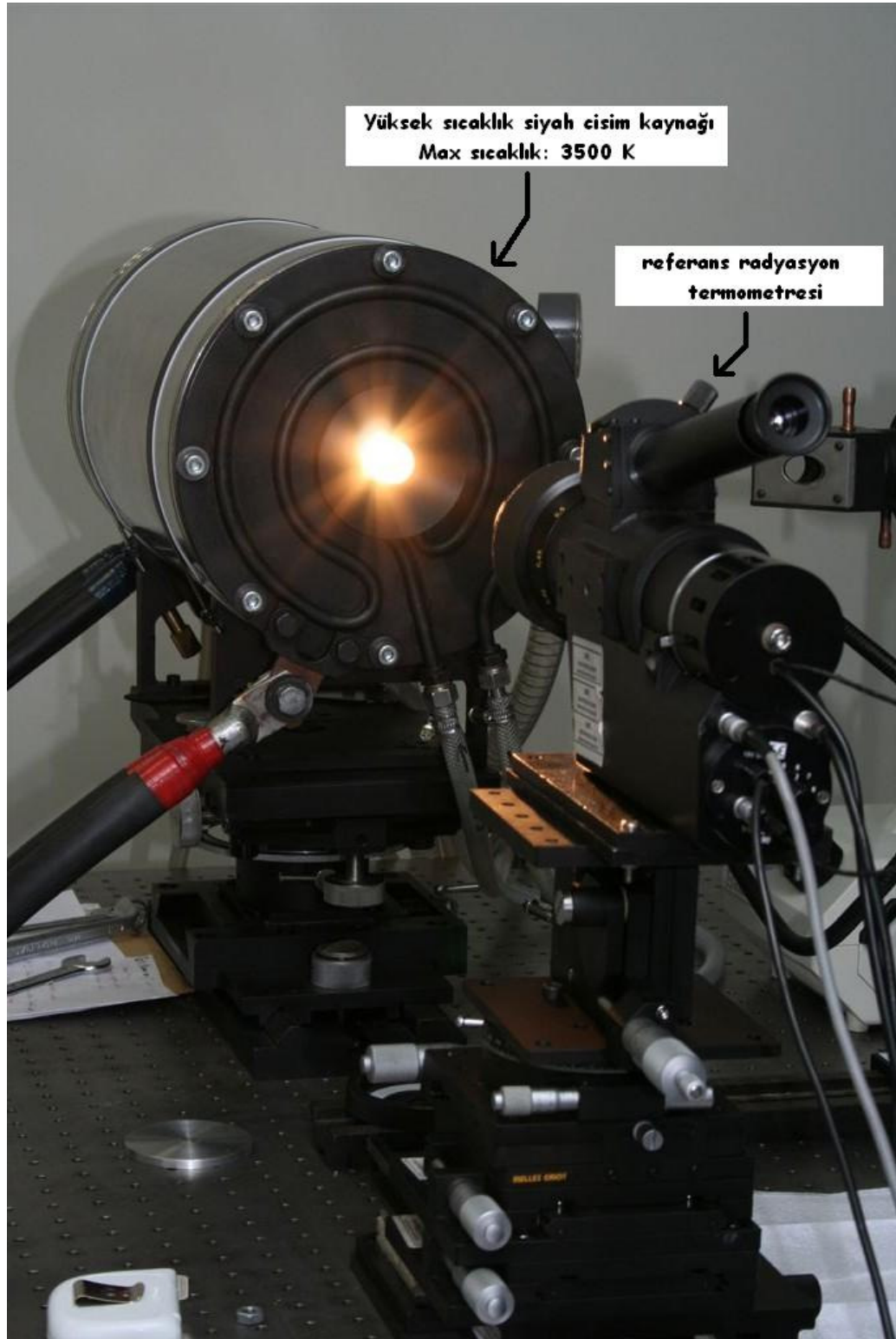
Şekil 3.16 Siyah cisim karşısında TSP-2 radyasyon termometresi
