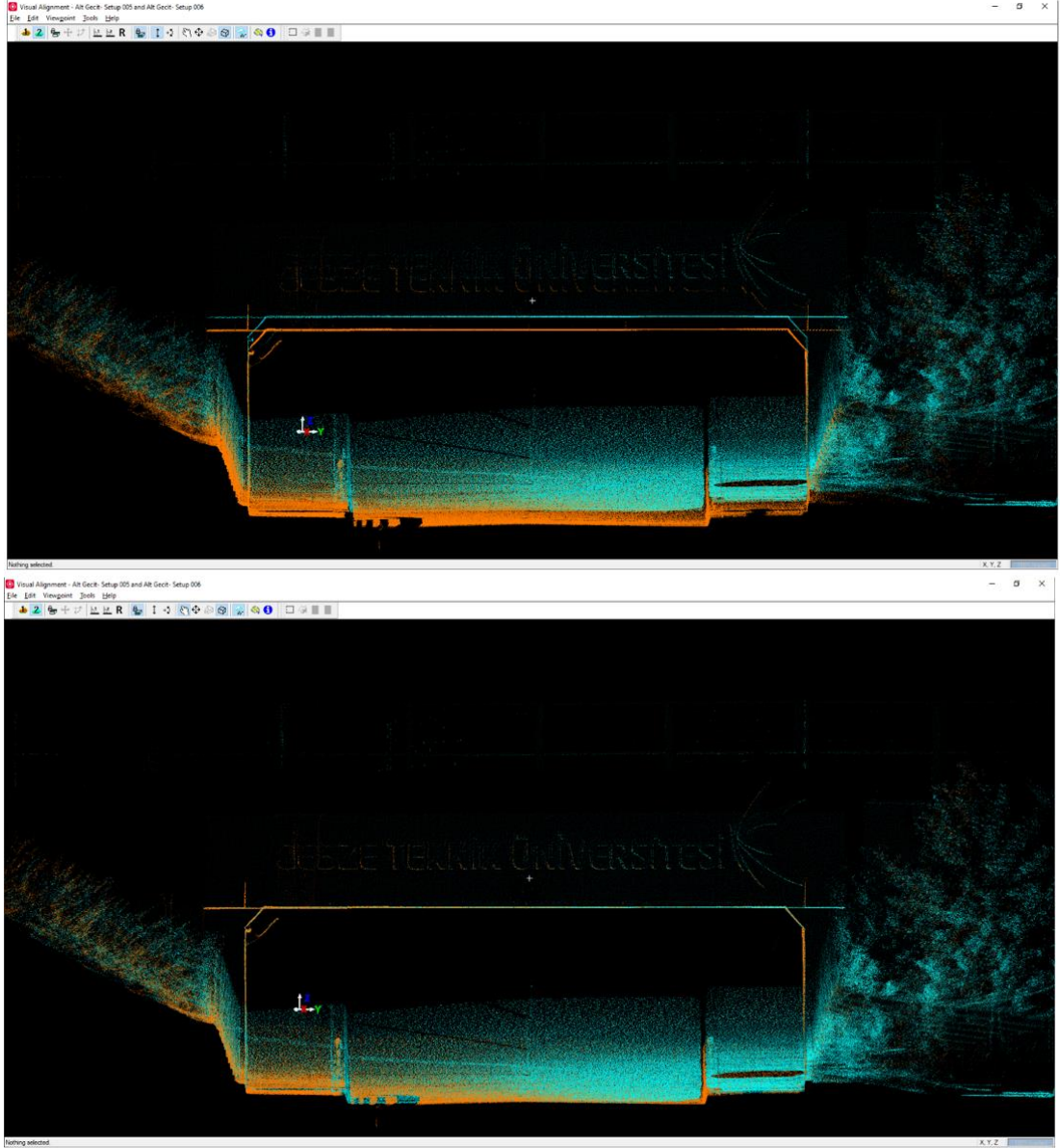
Şekil 4.12: TLS nokta bulutu çiftlerinin ön-birleştirilmiş (üst) ve düzeltilmiş (alt) halleri.
