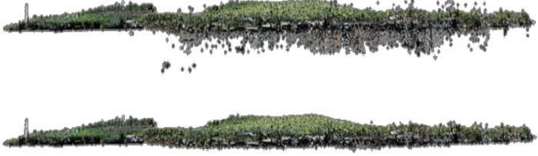
Şekil 4.8: Filtreleme etkisi: (üst) filtreleme öncesi, (alt) filtreleme sonrası.
