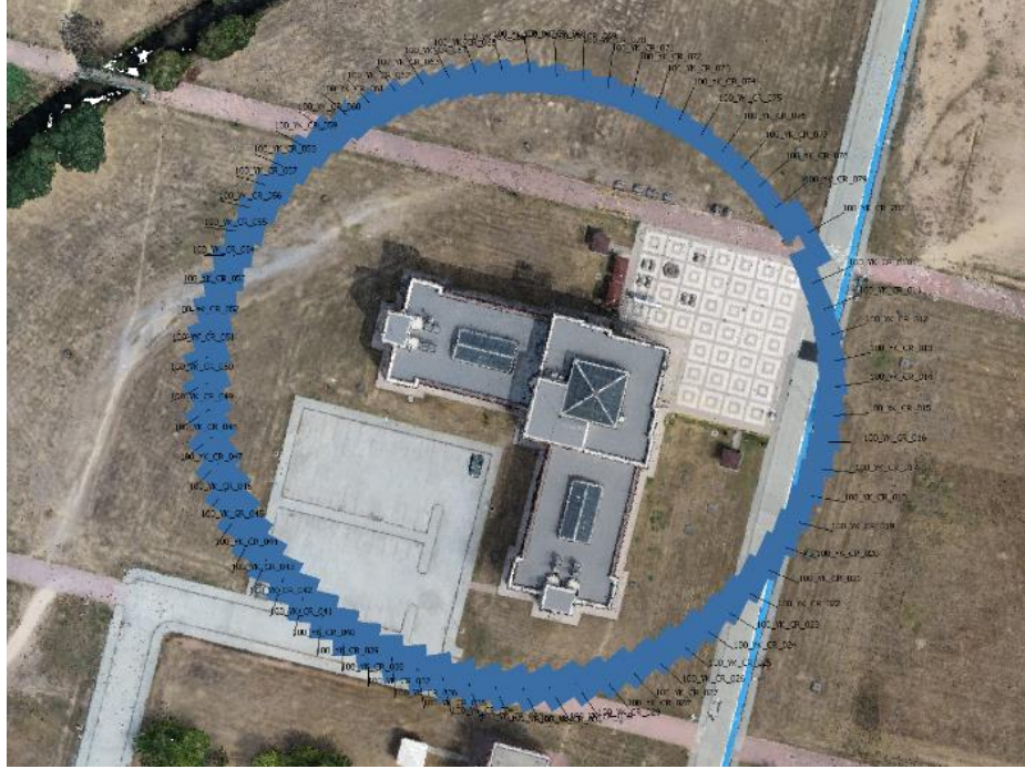
Şekil 4.5: SfM algoritması dairesel eşleştirme örneği
