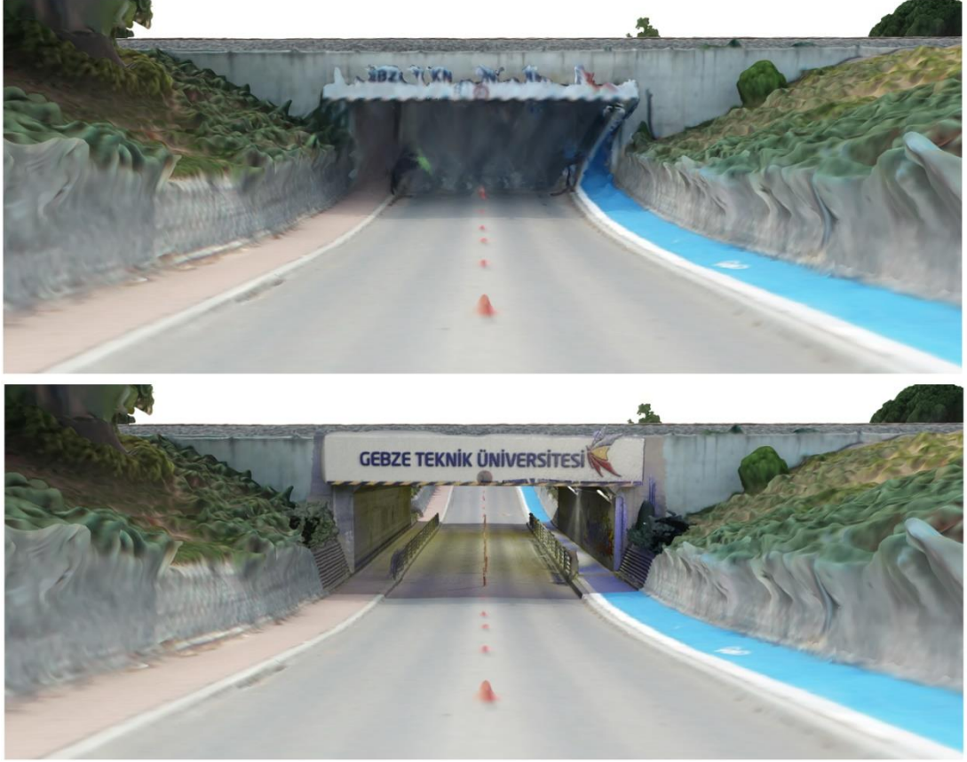
Şekil 5.3: İHA DT (üst) ve İHA ve TLS füzyonu sonucu DT (alt): Marmaray alt geçidi örneği.
