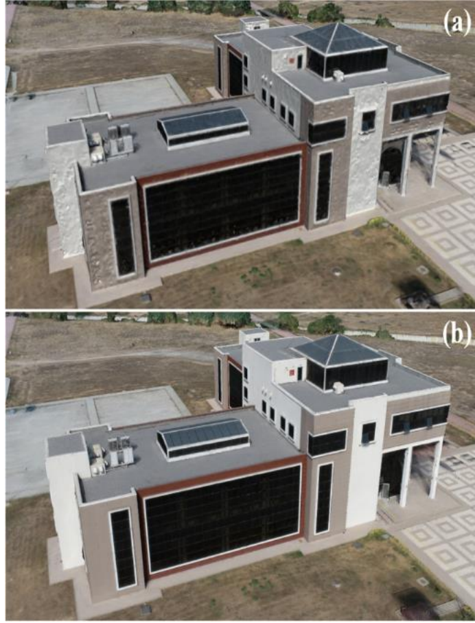
Şekil 4.9: Örnek bir bina üzerinde (a) doku giydirme öncesi ve (b) doku giydirme sonrası 3B DT görselleri.
