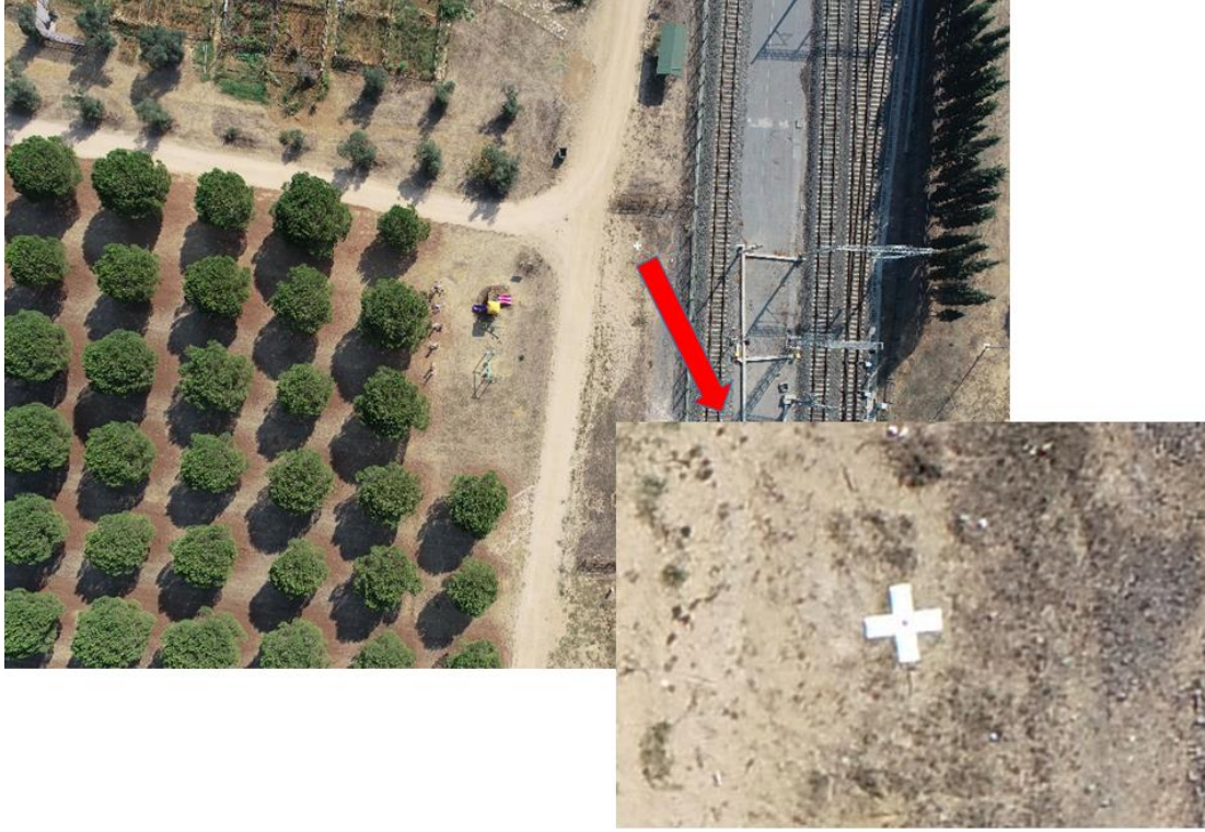
Şekil 4.7: Tesis edilmiş bir YKN'nin hava fotoğraflarında görünümü.
