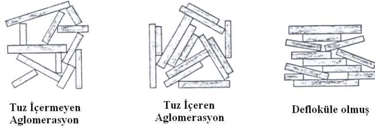
Şekil 2.1 Kenar-yüzey heteropolar etkileşimi, tuz destekli koagülasyon, ve defloküle olmuş çamurun sedimentasyonunda çift tabakanın üst üste gelmesi ile şekillenen kil aglomerlerinin tane yapısı.
