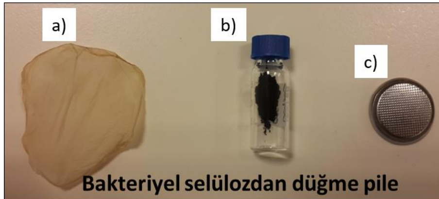
Şekil 6.13: Bakteriyel selülozundan anot elektrot eldesi ve şarjedilebilir bataryalarda kullanımı. a) Kurutulmuş bakteriyel selüloz, b) pirolize bakteriyel selüloz (PBS-500) ve c) Na-iyon düğme pili.
