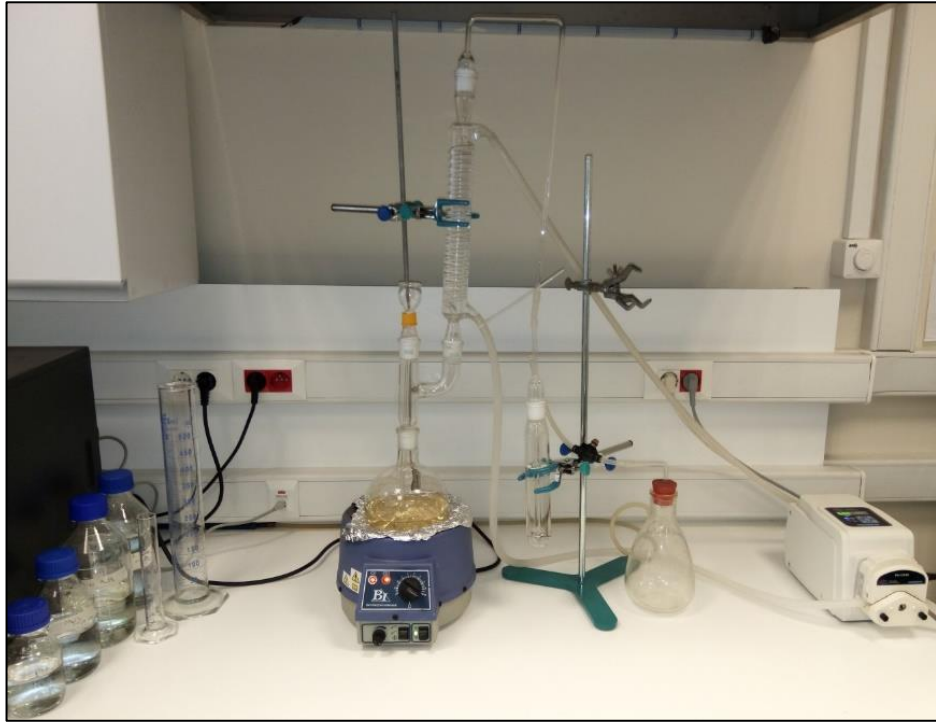
Şekil 3.10: Toplam siyanür analizi için kullanılan kaynatma sistemi.
