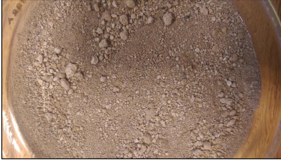
Şekil 5.22: Karışık endüstriyel arıtma çamurunun SKSO prosesi sonrasında oluşan kalıntı madde.
