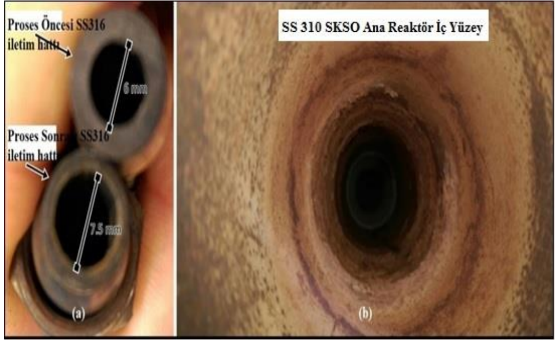
Şekil 5.24: SKSO pilot proses üzerinde a)iletim hattı SS 316 b) ana reaktör SS 310 deneyler sonrası görüntüsü.
