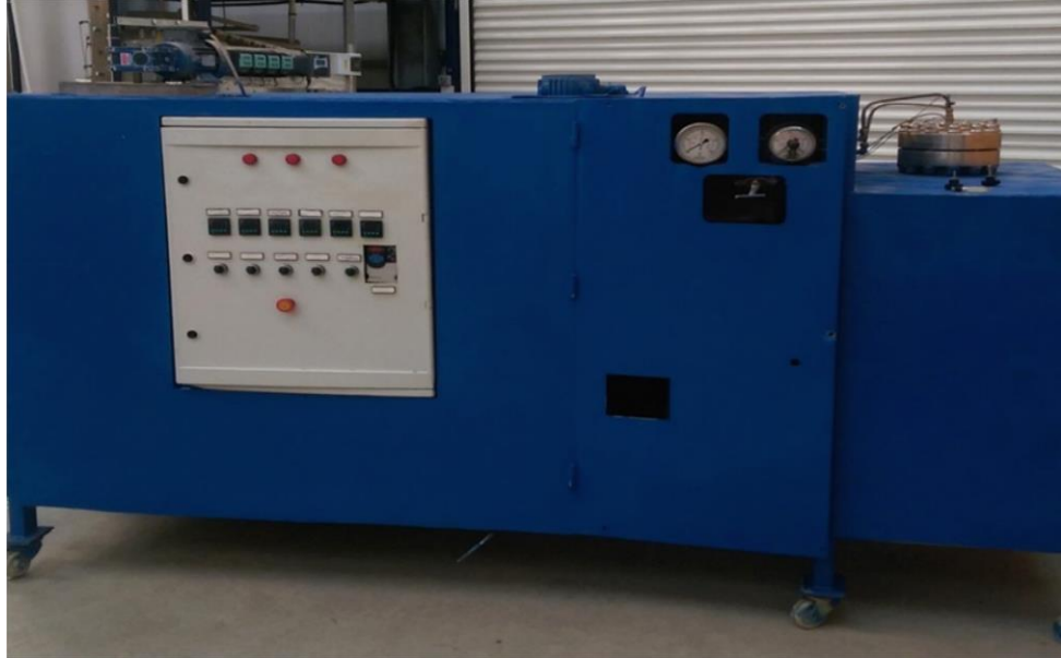
Şekil 4.3: Pilot ölçekli süperkritik su oksidasyon prosesi.
