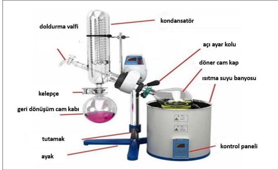
Şekil 3.4: Vakum damıtması.
