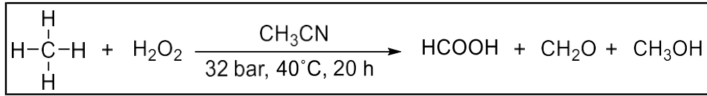
Şekil 3.6: \text{H}_2\text{O}_2 oksidantı kullanılarak oluşan metan oksidasyonu.
