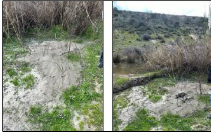
Şekil 6. 88: Mansap topuğu yakınında oluşan kum kaynamaları, sivilaşma.
