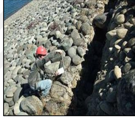
Şekil 4. 14: Mamba şevinde mamba yönlü yanal hareket.
