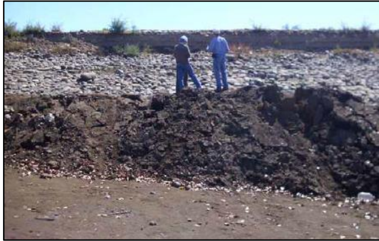
Şekil 4. 20: Memba topuğunda kabarma Şili Depremi Mw 8.8.
