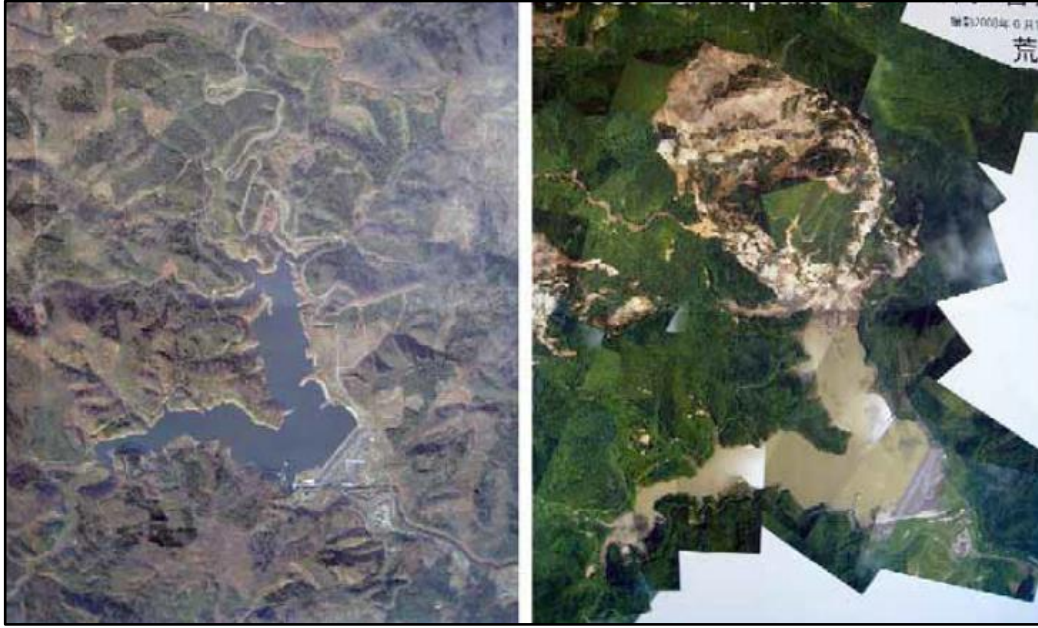
Şekil 4. 23: Aratozawa Barajı büyük rezervuar heyelanı deprem öncesi ve deprem sonrası uydu görünümü.
