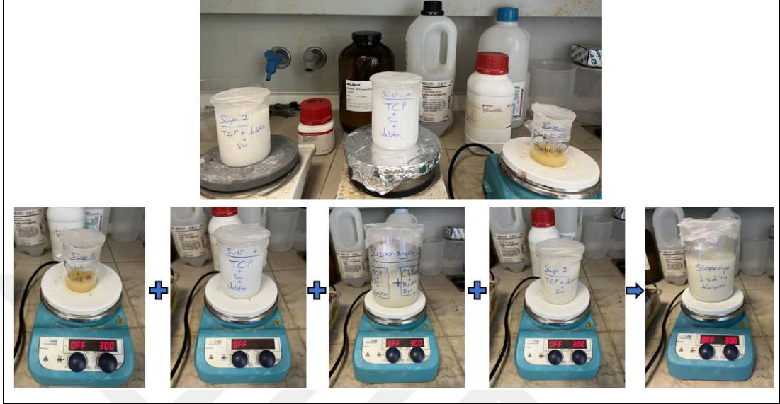
Şekil 5.30: Sol-Jel Süspansiyonunun Hazırlanması.
