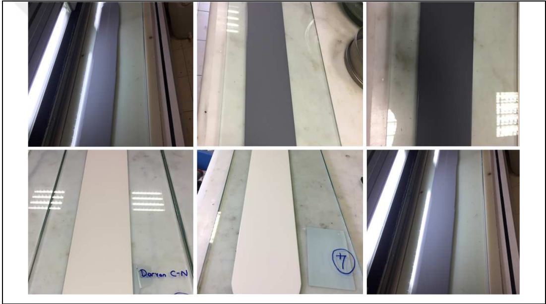
Şekil 5.3: DARVAN C-N Dispersanı Esaslı Şerit Dökümü Fotoğrafları.
