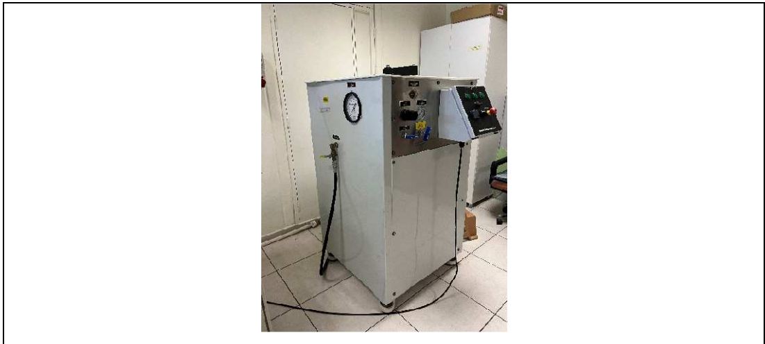
Şekil 4.7: Quintus Tecknologies marka Soğuk İzostatik Presleme (CIP) Cihazı.
