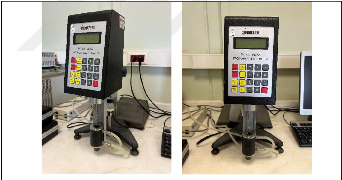
Şekil 4.5: Brookfield DVIII ULTRA Marka Reometre Cihazı.
