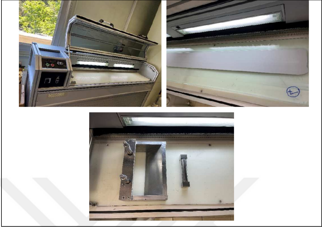
Şekil 4.6: MSE TC-0901AL Marka Şerit Döküm Cihazı.
