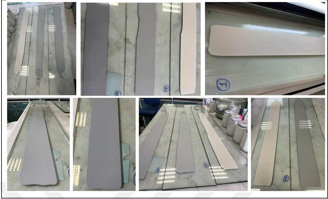
Şekil 5.4: PEI Dispersanı Esaslı Şerit Dökümü Fotoğrafları.
