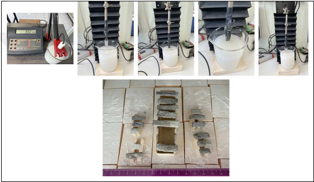
Şekil 5.32: Sol-Jel Daldırma Yöntemiyle Kaplama İşlemi.
