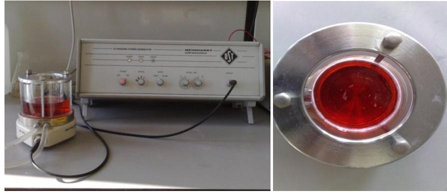
Şekil 4.3: US deney düzeneği ve US reaktörün yukarıdan görünüşü.
