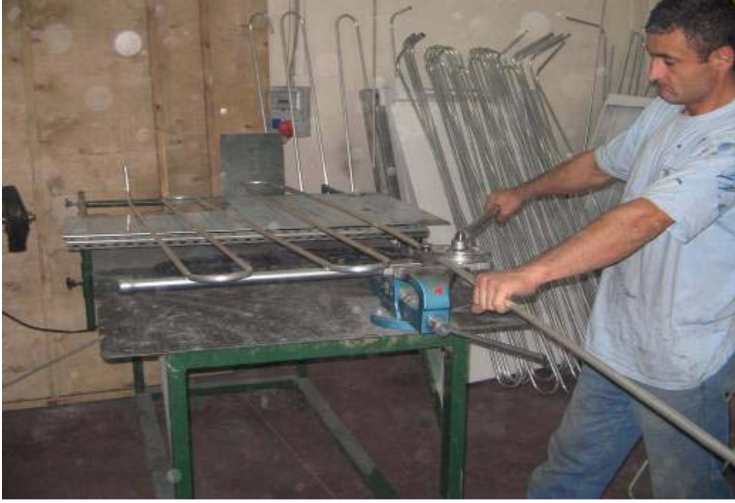
Resim 11.2. Alüminyum boruların bükülmesi
