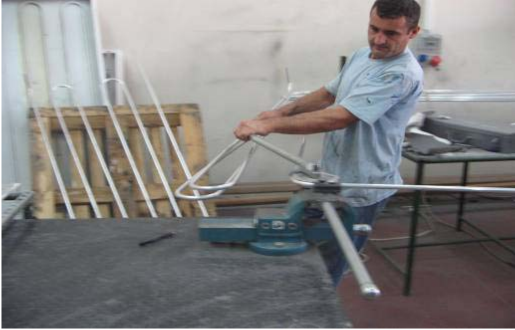
Resim 11.3. Alüminyum boruların bükülmesi
