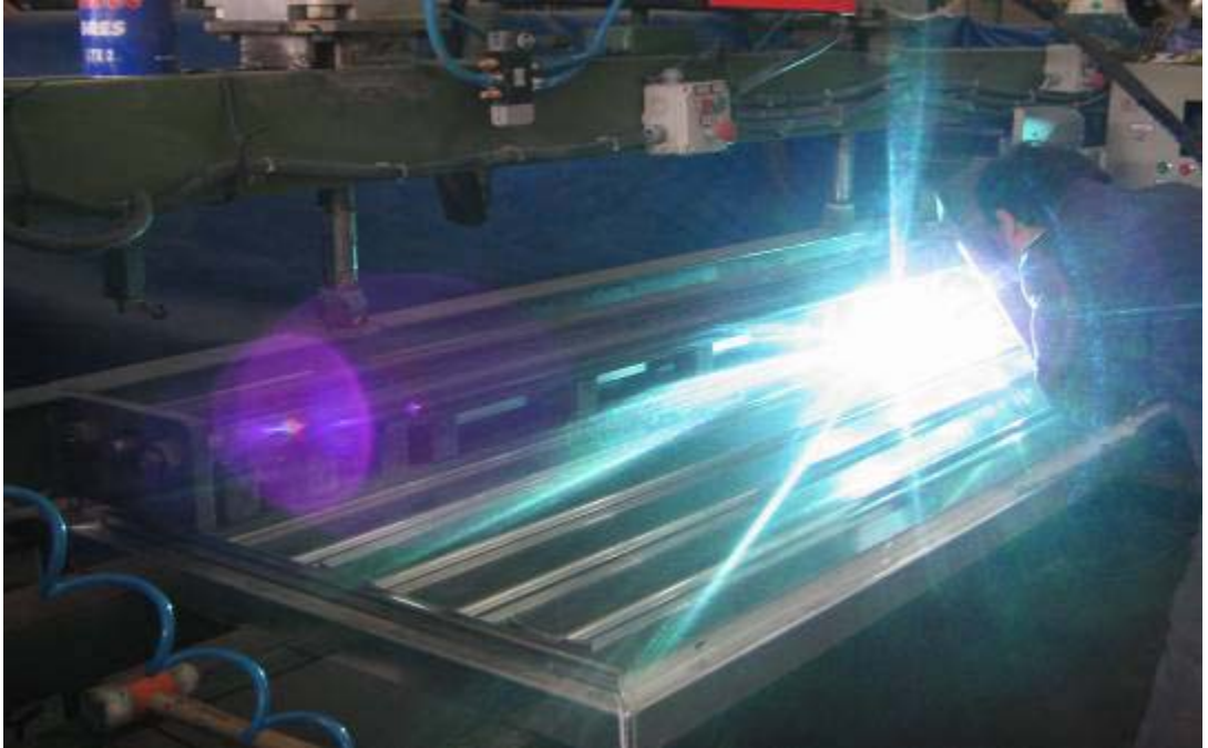
Resim 11.12. Alüminyum borunun tava'ya metod kaynağı ile kaynatılması
