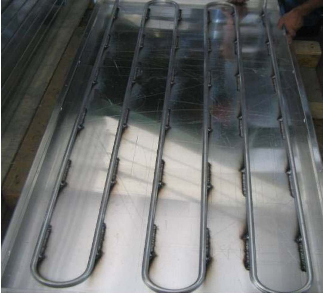
Resim 11.18. Alüminyum borunun tava'ya metod kaynağı ile kaynatılmış hali
