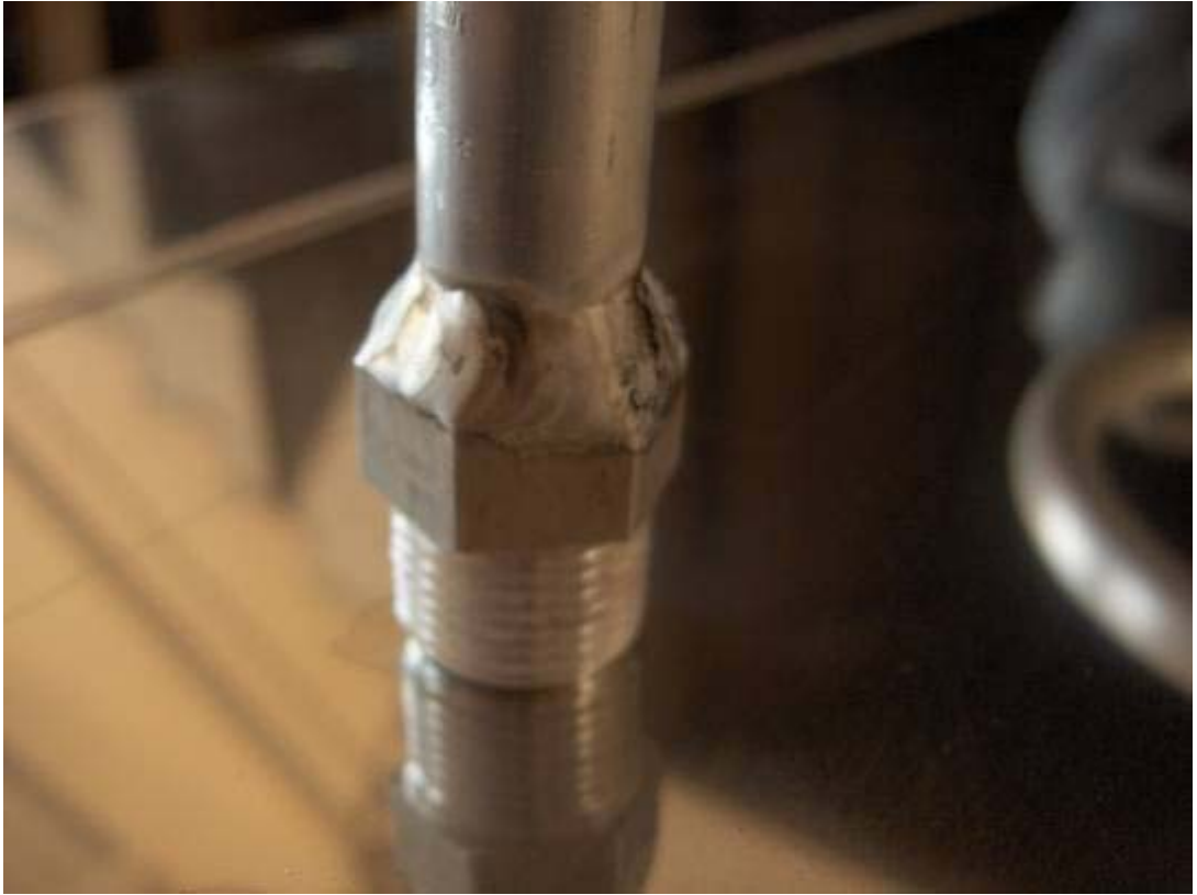
Resim 11.10. Alüminyum borunun uçlarına rakorun kaynatılmış hali
