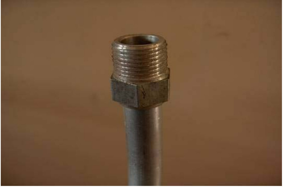
Resim 11.7. Alüminyum borunun uçlarına rakorun kaynatılması
