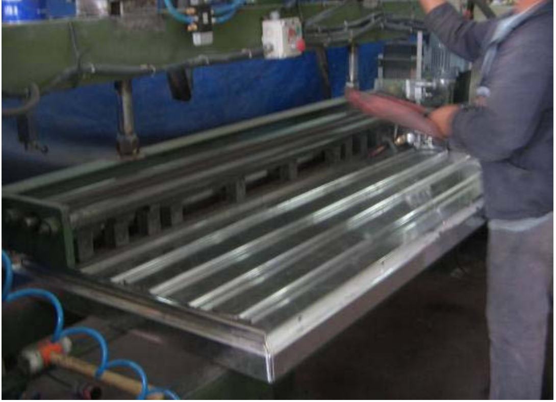
Resim 11.11. Alüminyum borunun tava'ya metod kaynağı ile kaynatılması
