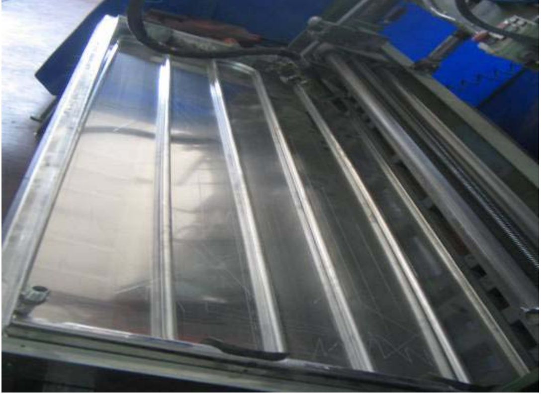
Resim 11.15. Alüminyum borunun tava'ya metod kaynağı ile kaynatılması
