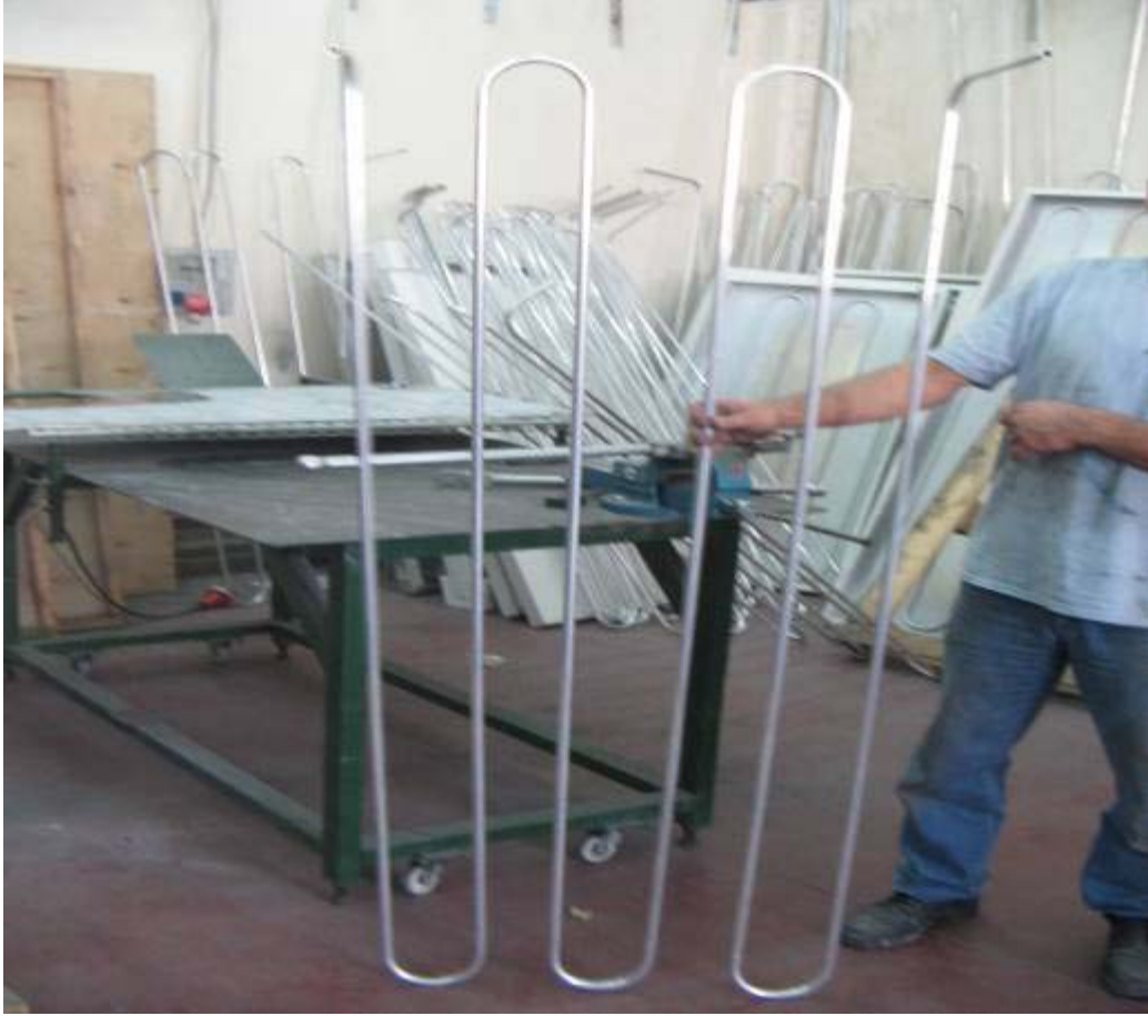
Resim 11.4. Alüminyum boruların bükülmüş hali
