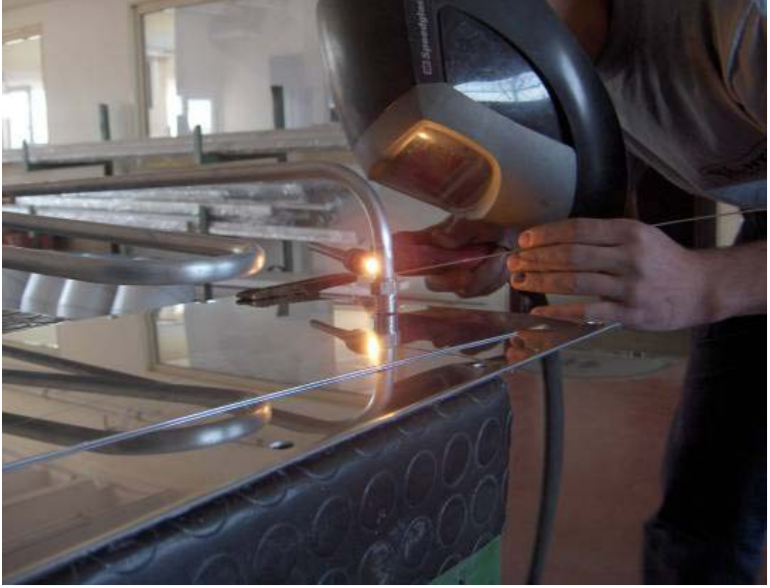
Resim 11.9. Alüminyum borunun uçlarına rakorun kaynatılması
