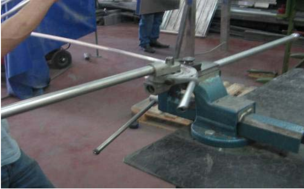
Resim 11.1. Alüminyum boruların bükülmesi
