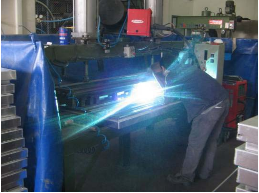
Resim 11.13. Alüminyum borunun tava'ya metod kaynağı ile kaynatılması
