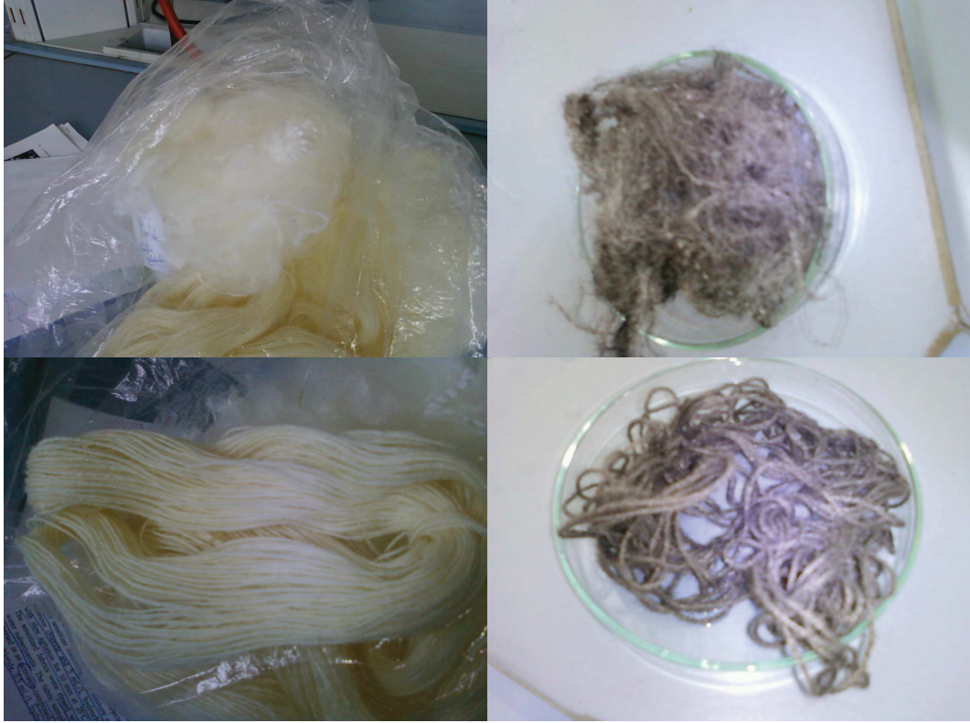
Şekil 3.5. Kaplama öncesi ve sonrası PAN fiber ve iplik
