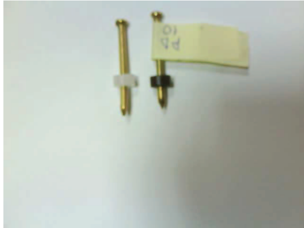
Şekil 3.3. Ölçüme hazırlanmış düzgün torroid şekilli numuneler.
