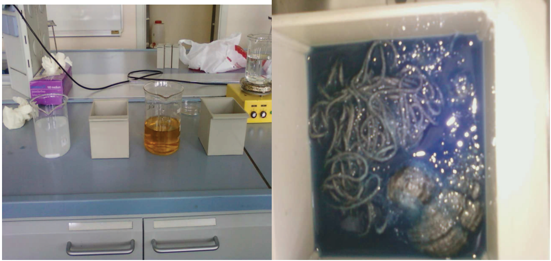
Şekil 3.4. Akımsız metal kaplama banyo düzeneđi ve kaplama esnasından görünüm
