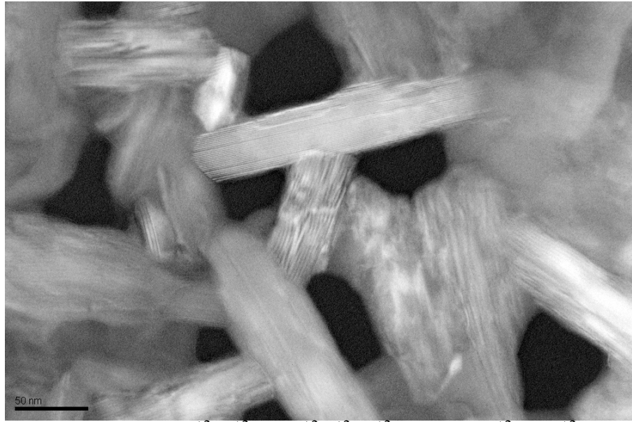
Şekil. 4.14. \text{Ba}^{+2}\text{Fe}^{+2}_{10}(\text{Mn}^{+2}\text{X}^{+2}\text{Zn}^{+2})\text{O}_{19} için \text{X}^{+2} = \text{Zn}^{+2} numunesine ait TEM resmi. Referans uzunluk 50 nm dir
