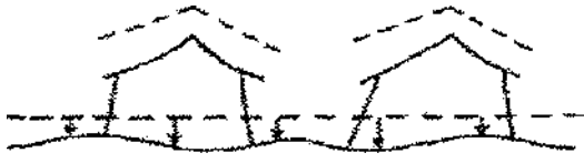
(a) Yoğunluk değişimi nedeniyle oluşan zemin hasarı
