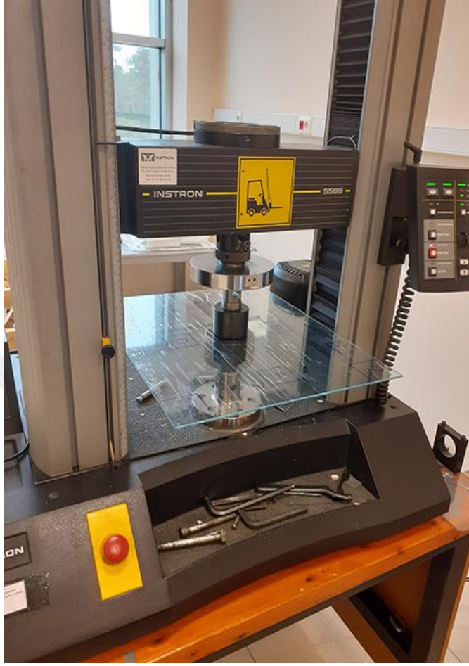
Instron® 5569 Model Mekanik Test Cihazı Vasıtasıyla Mukavemet Testi Uygulanması
