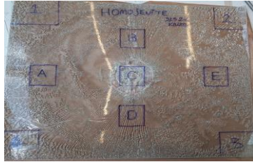
Kırılan Numuneneye Ait Homojenite Ölçüm Bölgelerinden Kırık Parçalarının Alınması İşlemi
