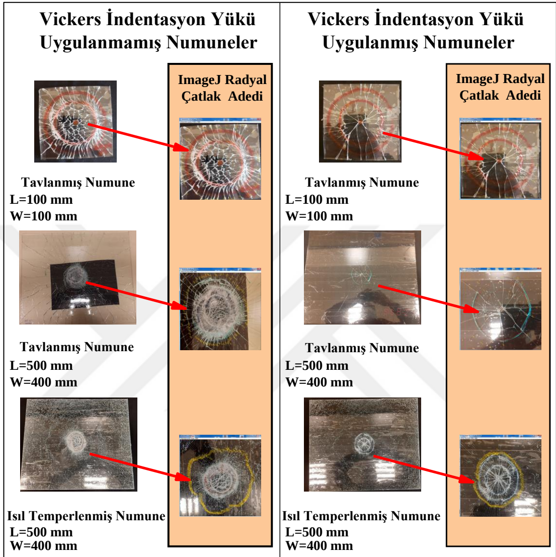
Şekil 3.8: Boyut, ısıtma işlemi ve Vickers indention yükü parametrelerine bağımlı olarak test numunelerinin kırılma davranışı ve ImageJ programı vasıtasıyla 100 mm x 100 mm yüzey alanı üzerinden belirlenen radyal çatlak adetleri.
