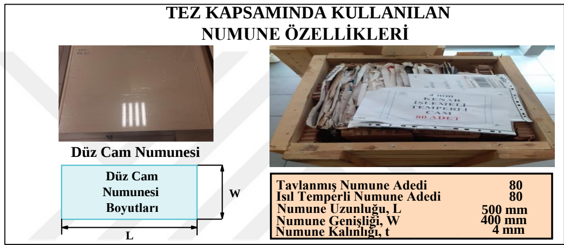
Şekil 3.1: Tez kapsamında kullanılan düz cam numune özellikleri.
