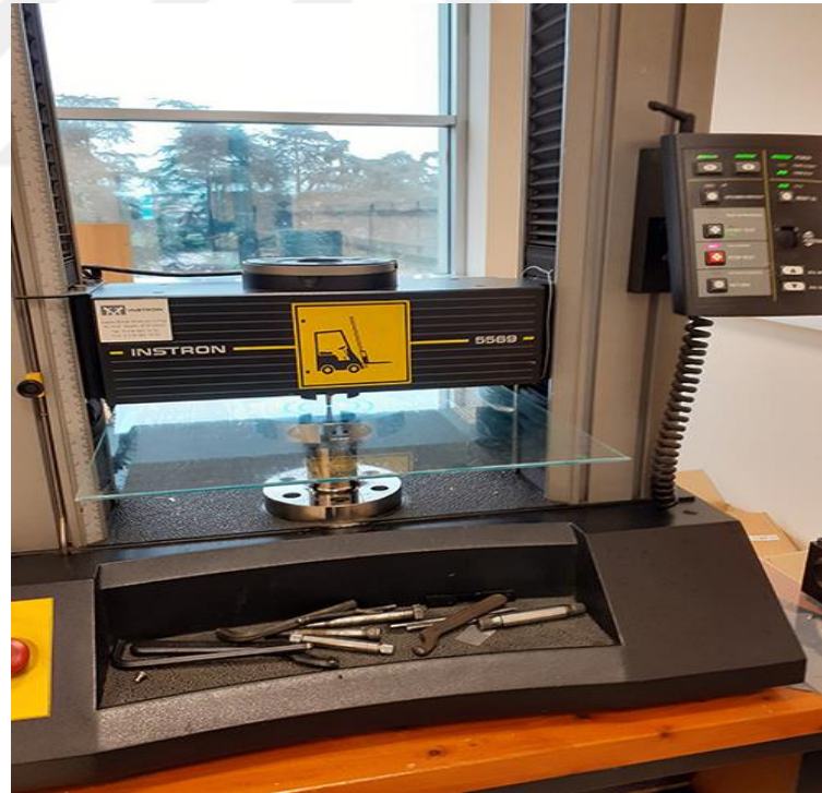
Test Numunelerinin Merkez Bölgelerine Vickers İndentasyon Yükü Uygulanması
