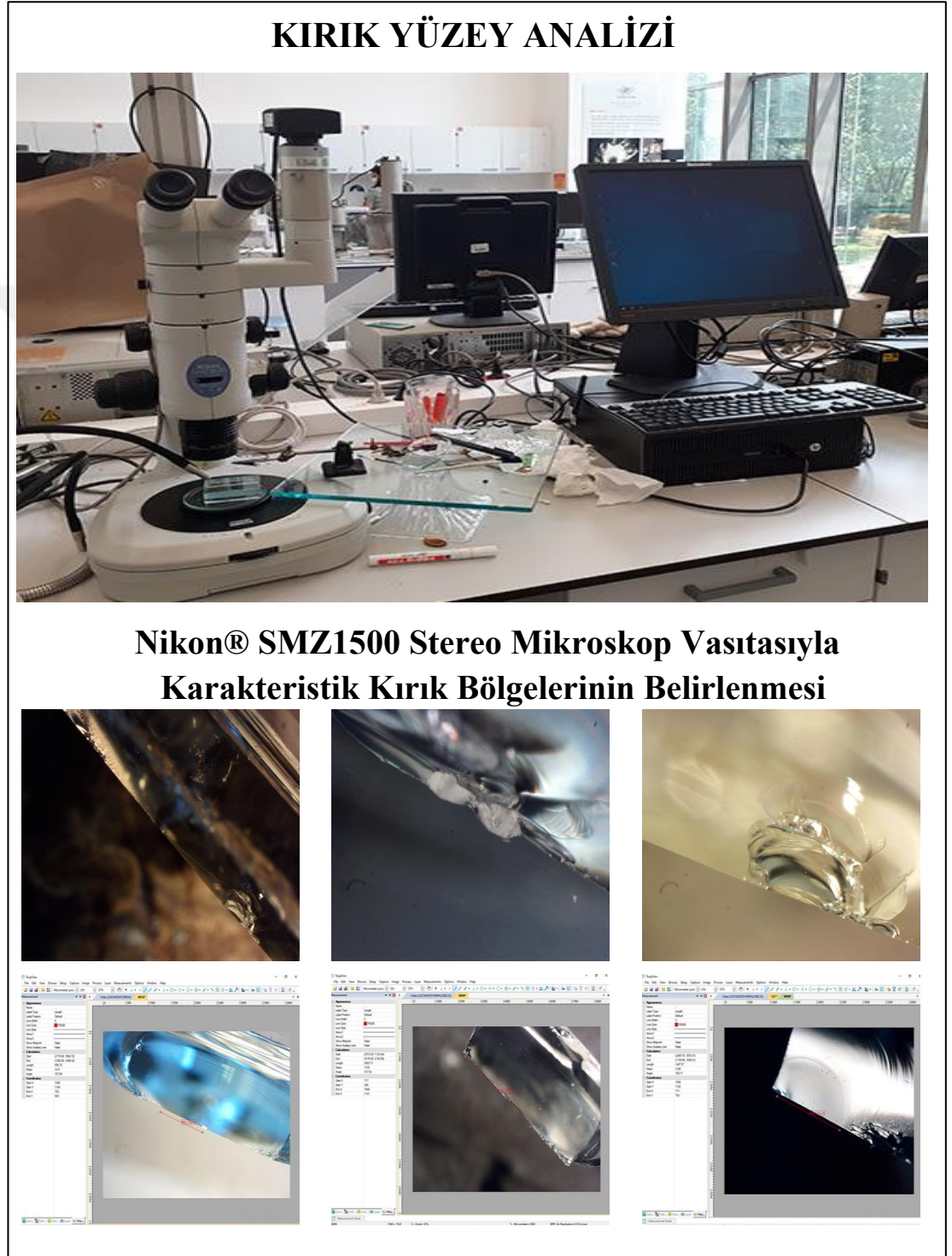
Şekil 3.9:Nikon® SMZ1500 Stereo Mikroskop vasıtası ile karakteristik kırık yüzeylerinin belirlenmesi.
