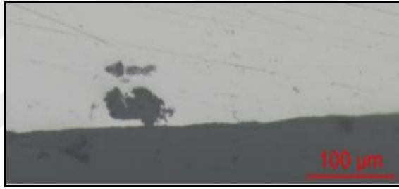
Şekil 4.3: AA 2050 T8 alaşımında oluşan pitting korozyonu.
