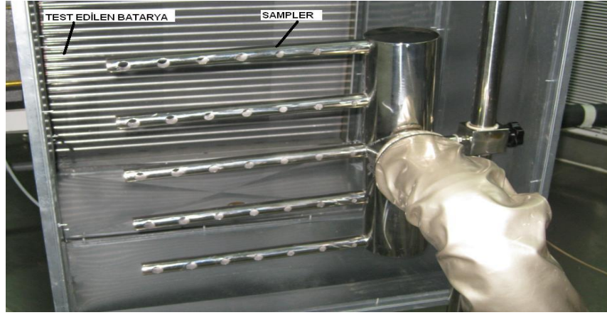
Şekil 3.17: Hava giriş tarafına sampler yerleştirilmesi.
