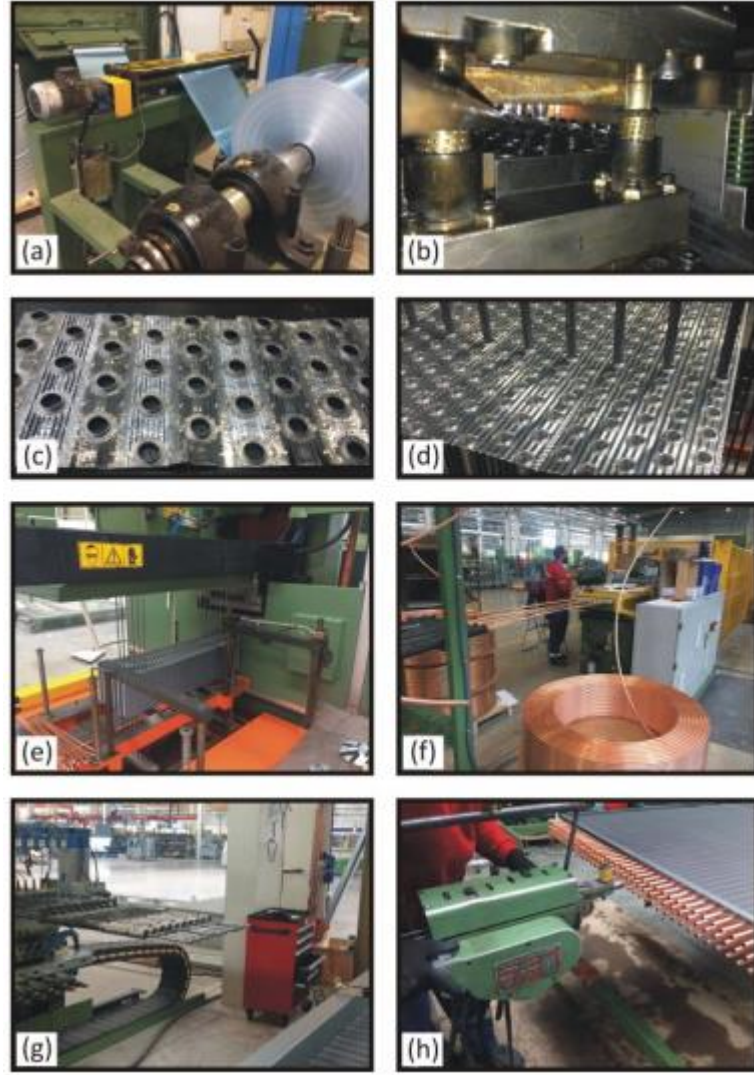
Şekil 3.10: Test edilen ısı deęiřtiricilerinin imalatı. (a) Kanatlar için alüminyum malzemenin kesilmesi, (b) alüminyum malzemenin saç kalıptan geçirilerek panjurlu ve dalgalı yapının verilmesi, (c) panjurlu kanat örneęi, (d) dalgalı kanat örneęi, (e) kanatların borulara dizilmesi, (f) boruların kesilmesi, (g) ve (h) boruların şiřirilmesi iřlemi.
