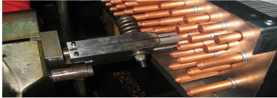
Şekil 3.8: Örnek bir manuel şişirme makinesi ve şişirme işlemi.
