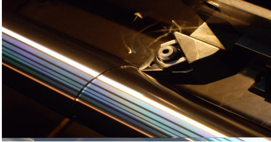
Şekil 5.3. CNC torna tezgahıyla talaş kaldırma işlemi.
